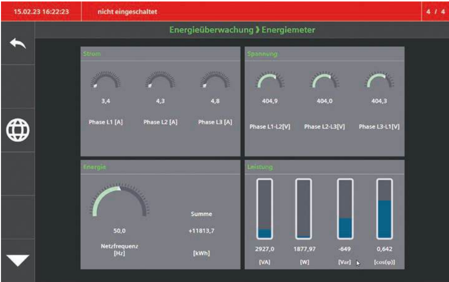
Abbildung 1: Energie Monitoring - Siemens-Energymeter-Werte
