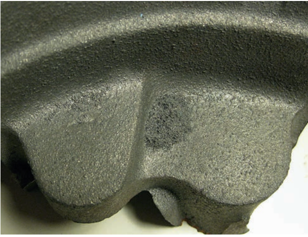
Bild 7.: Beispiel einer Sekundärpenetration, die auf Grund der Graphitexpansion bei der Erstarrung von Fe-C-Si-Legierungen, insbesondere bei naheutektischem GJL, auftreten kann aber z.B. auch beim Formguss von FeSi75-Legierungen zu beobachten ist.
