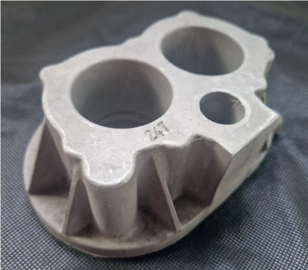
Gehäuseunterteil, Aluminium, ca. 1,2 kg, © HWS
