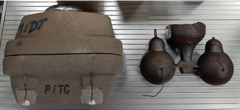
Bild 1.: Doppelkammertiegel, die seit nunmehr knapp 30 Jahren zur Überwachung des Erstarrungsverlaufes verschiedener Gußwerkstoffe mittels thermischer Analyse eingesetzt werden, ermöglichen den direkten Vergleich von unbehandelten und behandelten Schmelzen. Links der Tiegel bereits abgegossen mit einer Al-Legierung und rechts eine so entstandene GJS-Gußtraube mit zwei identischen, aber unterschiedlich behandelten Probekörpern [3].
