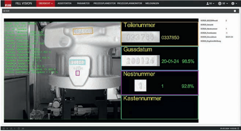
Die Teileerfassung durch Klarschrifterkennung bringt nicht nur Nachvollziehbarkeit, sondern ermöglicht durch formnestspezifische Programmvarianten eine einheitlich hohe Bearbeitungsqualität. Bild: © Fill
