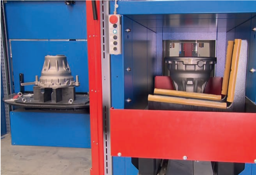
Im GRIND PERFORMER werden Eisengussteile ohne spezifische Aufnahme per Rundtisch eingebracht, vollautomatisch von Speisern und Graten befreit und am Ende ausgefördert – so bearbeitet, dass keine Nacharbeit mehr erforderlich ist. Bild: © Fill
