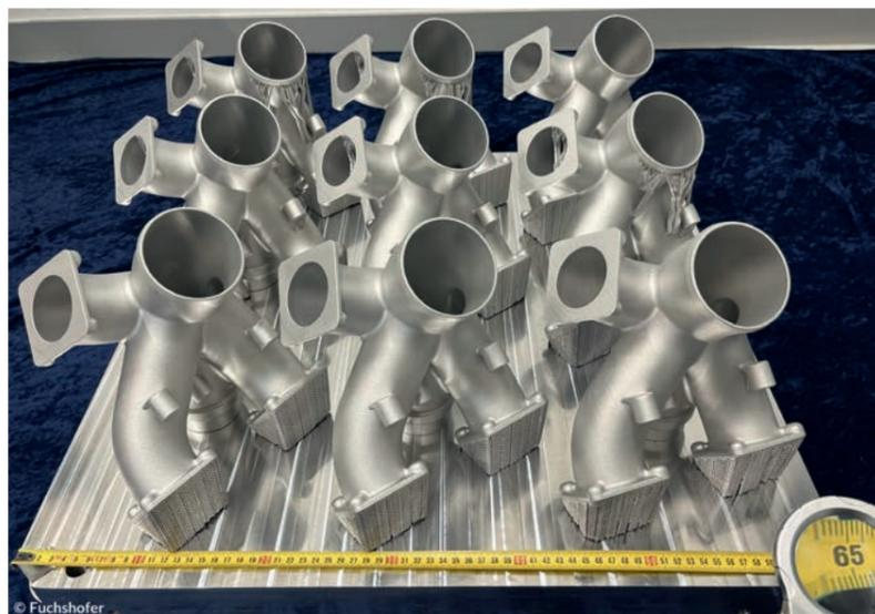
Großformatdrucker EP-M650 von Eplus3D eroberte die Fertigungswelt. Mit einem beeindruckenden Bau-raum von 650x650x800 mm und der Fähigkeit, Bauteile bis zu 850 mm zu drucken, katapultierte diese Technologie die Branche in eine neue Ära. Kleinserien und selbst komplexe Großbauteile sind nun mit bisher unerreichter Effizienz möglich.
