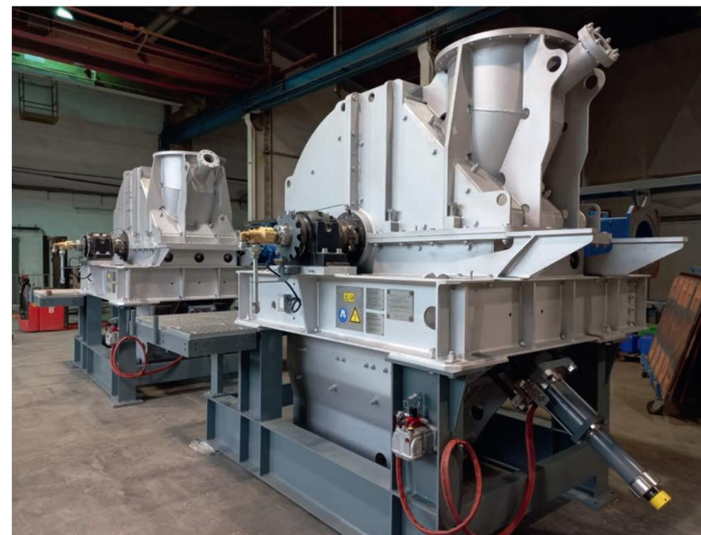
MFL Feeder für Heißgutförderung in Stahlproduktionsanlagen
