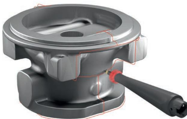
Eindeutige Referenzflächen und die grafische Darstellung der Werkzeugbahn ermöglichen insbesondere bei komplexen dreidimensionalen Freiformflächen eine präzise Pfadplanung ohne Berücksichtigung der Gesamtabweichungen des Bauteils. © Fill
