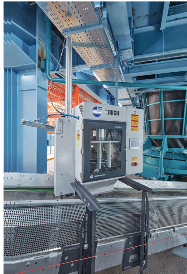
Abb. 3 Inline-Prüfgerät QualiMaster AT1 (Bild Eirich)
