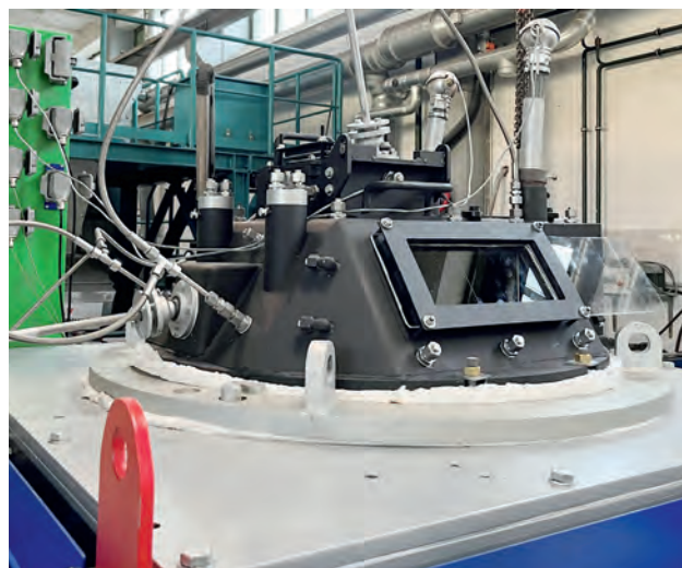
Bild 2: Blick auf die am RAUCH-Versuchsofen angebrachten Sensoren für die Steuerung und Nachverfolgung des Ofenprozesses. Beim Ofenbetrieb werden Parameter wie Temperatur im Ofenraum, Schmelzbaddtemperaturen in unterschiedlichen Zonen und im Gasraum aufgezeichnet und um die eingestellten Gasparameter wie Zusammensetzung, Mischverhältnis und Flussrate ergänzt.
