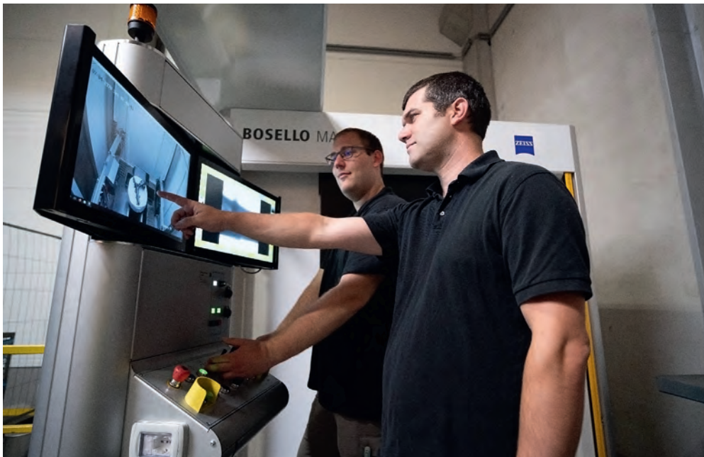
Bild 13. 2D-Röntgeninspektion mit ZEISS BOSELLO MAX im Atline-Betrieb (Quelle: ZEISS Industrial Quality Solutions, Foto: Manfred Stich)
