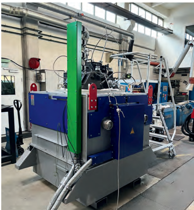
Bild 1: Der in Betrieb befindliche RAUCH-Versuchsofen im Gießereitechnikum des ÖGI.
