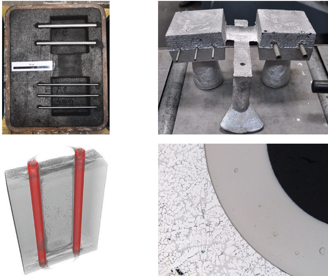
Bild 5: Vorversuche im Umgießen von Rohrleitungsmaterialien 2 .
