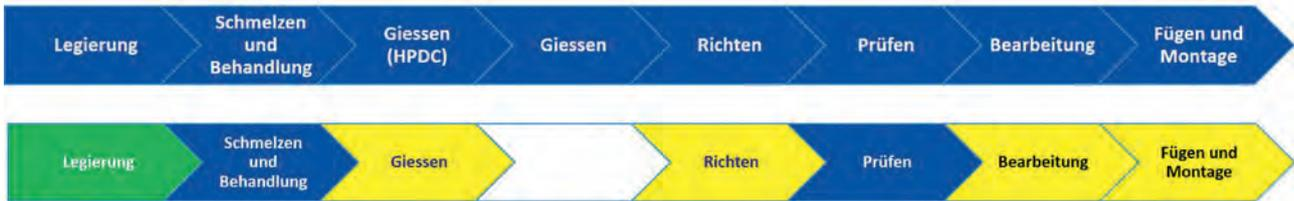
Bild 3: Prozessfluss für Strukturteile – oben bei Einsatz von Legierungen mit Wärmebehandlung, unten ohne Wärmebehandlung, z.B. mit Castasil-37™, Castaduct-42™ und Magsimal-plus™.
