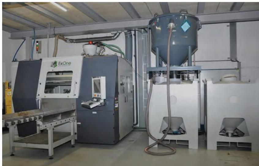
durch den losen Sand in der Jobbox gestützt, sodass keine zusätzlichen Stützstrukturen, die nachher entfernt werden müssten, erforderlich sind. Das Binder-Jetting-Verfahren hat im Vergleich zu anderen additiven Herstellungsverfahren eine sehr hohe Volumenleistung, d. h. eine sehr hohe Baurate.
