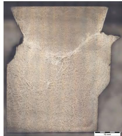
Bilder 8 a, b: Gussteilabschnitt mit Speiser und Speiseranbindung, rechts der geätzte Makroschliff aus diesem Bereich
