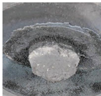
Bilder 2 a, b: Muldenbruch am Gussteil und verbleibender Zapfen am Speiser
