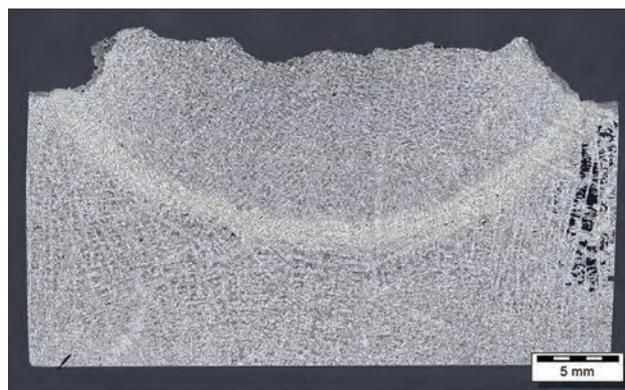
Bild 4: Makrobild mit ferritischem Halbkreisband unterhalb der Speiserbruchfläche. Man erkennt grobe Dendriten und Porositätsnester. Im Halbkreisband sind überwiegend entartete Graphitkugeln und NME eingebettet.
