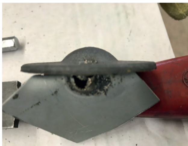
Bild 10: Reißprobe der Punktschweißung ( Zange )
