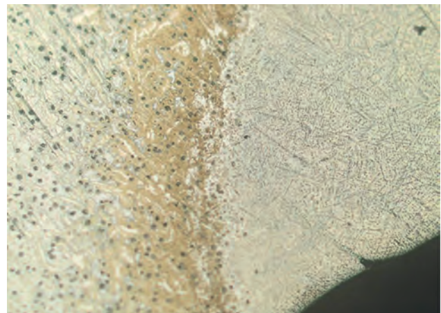
Bild 12: Gefügebildung des Laser Schweißverbundes
