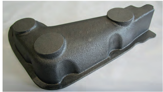
Bild 11: Versuchsteil Gussknoten im Werkstoff GJS 500
