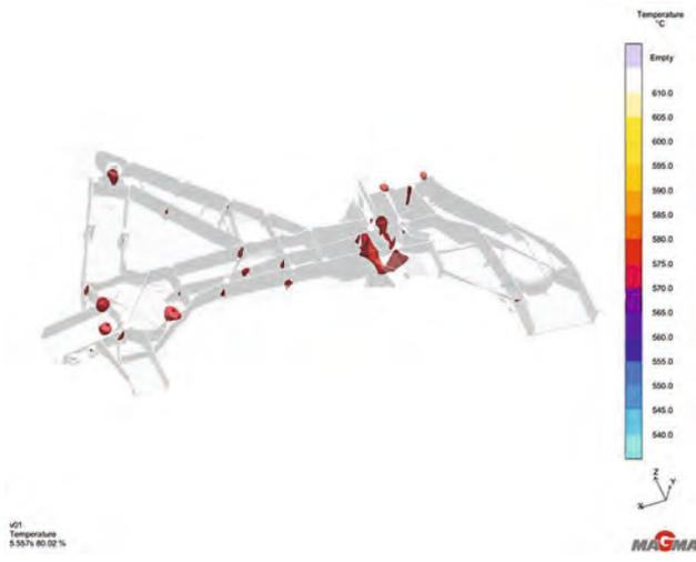
**Bild 17. Simuliertes Karosserieteil bezüglich der Erstarrungsschwerpunkte**
