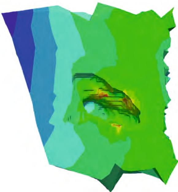
Bild 8. von Mises Spannungen in der Umgebung der Pore in einem realen Al-Druckgussbauteil
