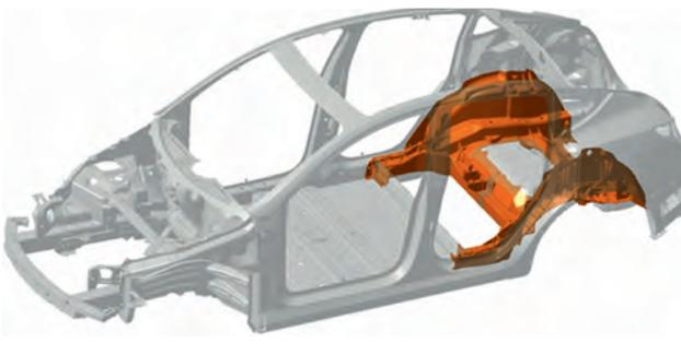
Bild 3. Vorschlag von Tesla für die Gestaltung der Karosserie eines PKW mit einem großflächigen Heckbauteil [7, 9 und 10]
