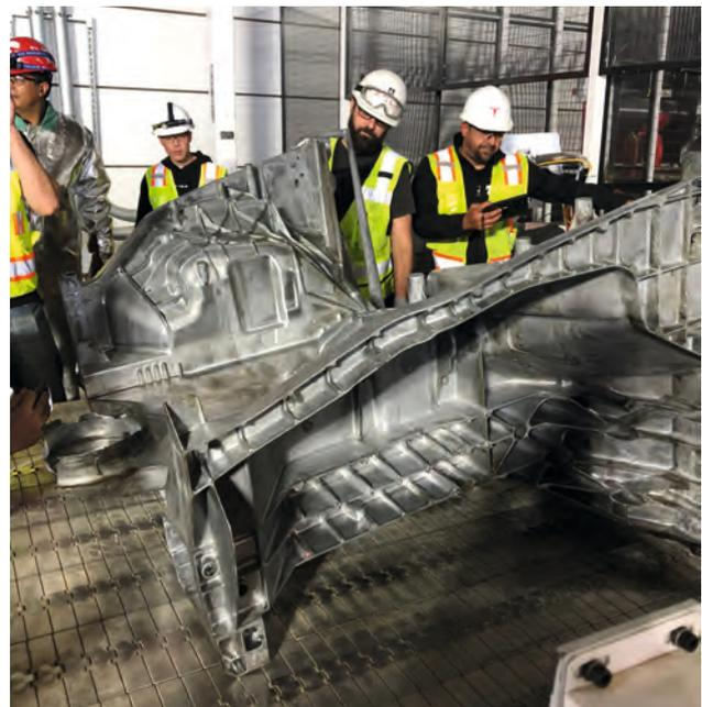
Bild 5. Vorderwagen des Modells Y von Tesla mit einem Stückgewicht von 130 kg aus druckgegossenem Aluminium [28]
