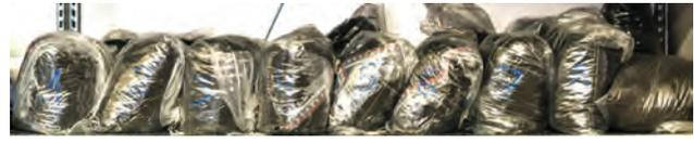
**Bild 2:** Probesäckchen (je ca. 5,5 kg Sandmenge) mit homogenisiertem Formsand aus einer Eisengießerei
