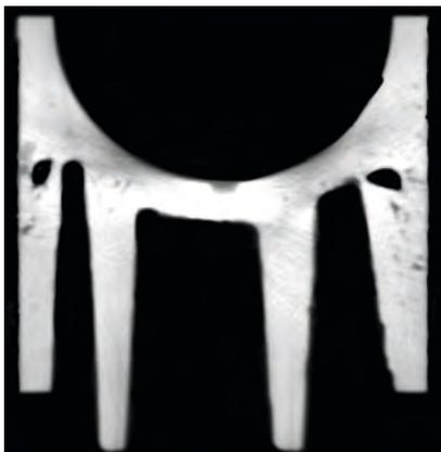
**Bild 6. Große Gasporen im Bereich der Rippen eines Leichtbauteils [14]**
