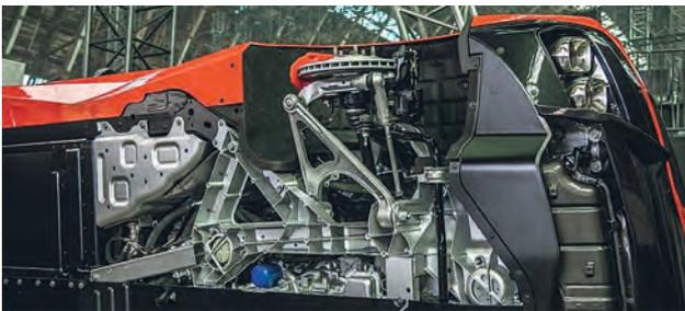
Bild 14. Untersicht auf das Fahrzeug mit dem großen Druckgussteil [42]
