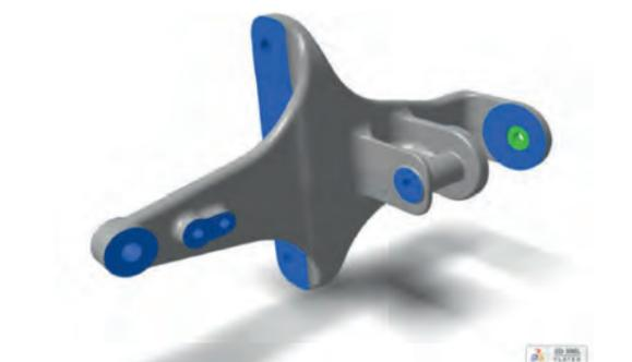
Konstruktionsentwurf belastet mit hohen Kerbspannungen
