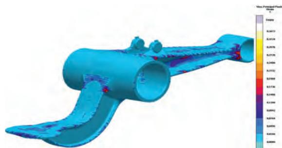
Konstruktionsentwurf belastet mit hohen Kerbspannungen
