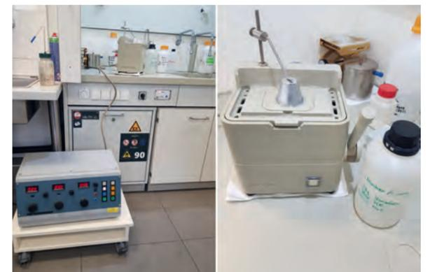
Abbildung 5: Elektrolytisches Barker Ätzgerät.
