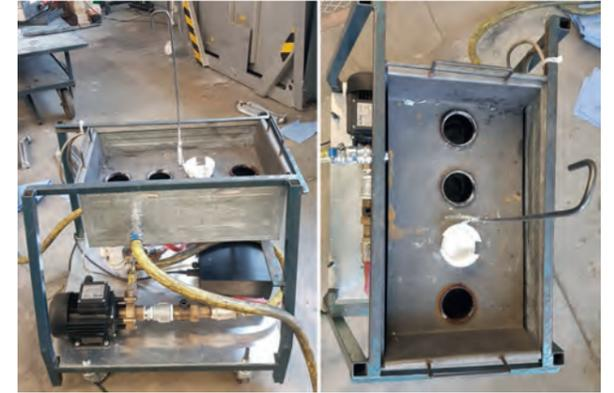
Abbildung 4: Vorrichtung für TP1 Test am Lehrstuhl für Gießereikunde.
