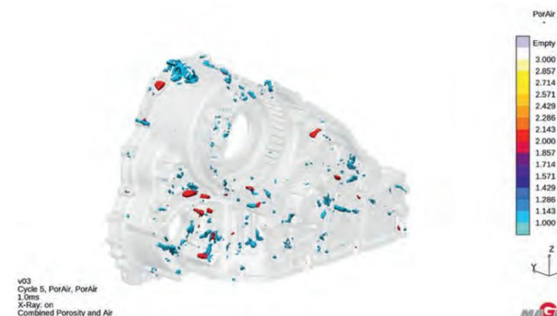
Abb. 2: Direkte Bewertung unterschiedlicher Gussfehler im Abgleich mit CT (blau: Luft, rot: Schwindungsporen)
