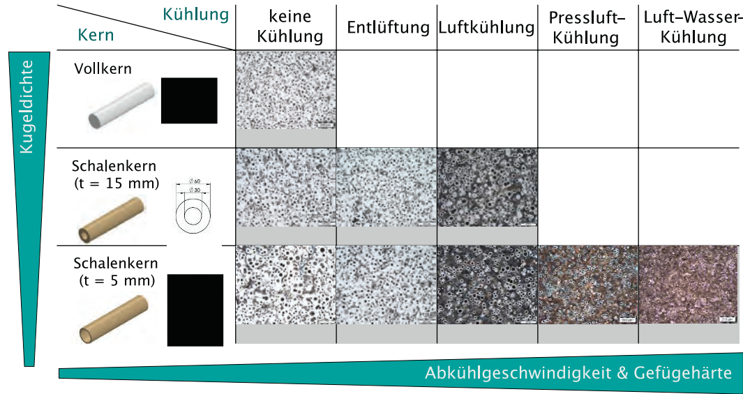
Abbildung 4.13: Gefügezusammensetzungen bei der Verwendung von Vollkernen und Schalenkernen sowie der Anwendung unterschiedlicher Kühlmethoden.
