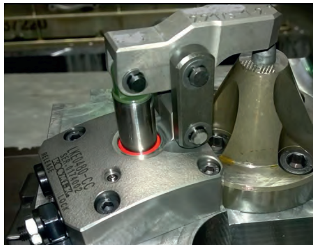
LKE High-Power-Hydraulik Spanner. Bei 60bar Druck 3,7 kN Spannkraft!
