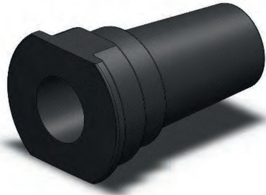
Abbildung 3.3: Prüfkörper mit stufenförmiger Außenkontur, hergestellt durch einen innenliegenden Kern.
