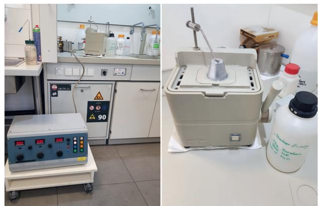
**Abbildung 5:** Elektrolytisches Barker Ätzgerät.
