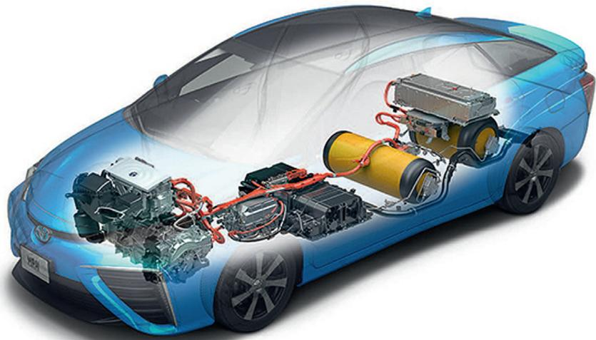
**Bild 7. Übersichtsdarstellung Brennstoffzellenfahrzeug Toyota „Mirai“, nach [29] mit freundlicher Genehmigung von Toyota**
