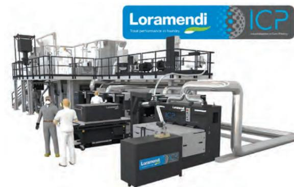
**Bild 7. Kernfertigungszentrum für gedruckte Kerne (Quelle: Loramendi Vertriebs GmbH)**
