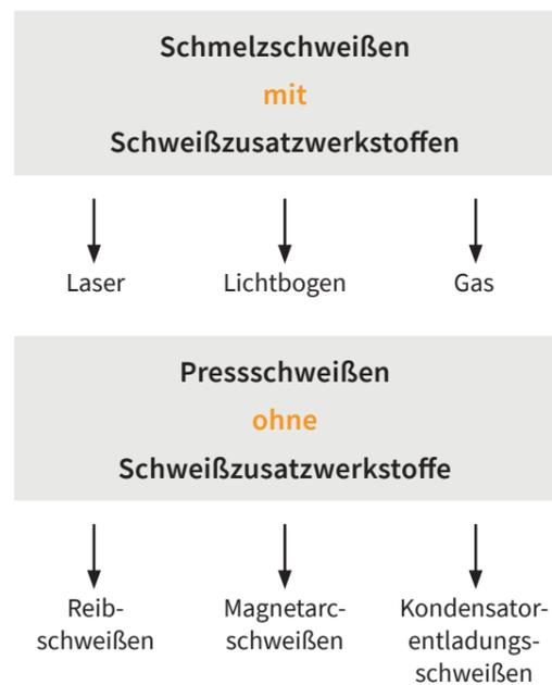
Bild 6: Mögliche Schweißverfahren zur Verbindung von (Leicht-) Gussteilen mit Stahlelementen.
