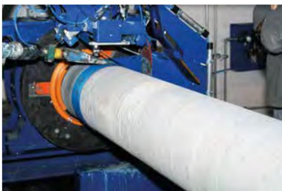
Das Aufbringen des Zementmantels auf das Rohr
