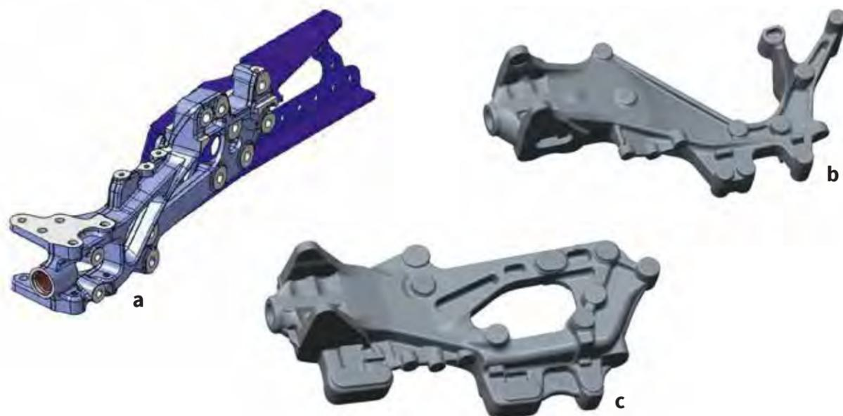
Bild 4: Entwicklung zur Verstärkung eines Fahrerhausträgers. a) Rahmenkopf mit Fahrerhausträger, b) Ausgangskonzept, c) Aktueller Geometriestand im Werkstoff Gusseisen mit Kugelgrafit (Gewichtersparnis 15%). © Franken Guss
