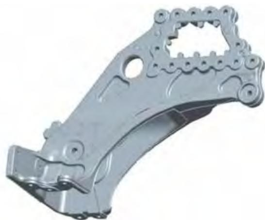
Bild 5: Neukonstruktion des vorderen Federbocks (Werkstoff: EN-AC-ALSi10Mg T6) (Gewichtersparnis 30%) © Franken Guss
