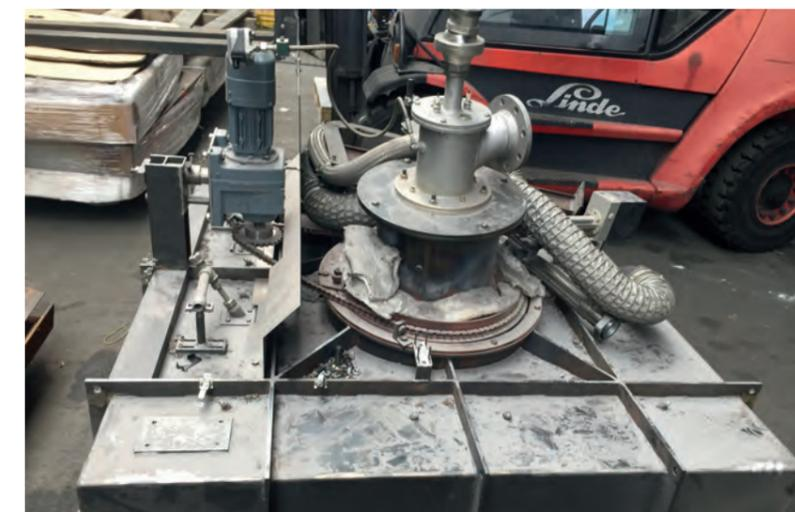
In weiterer Zusammenarbeit mit dem BMWi und der Bergakademie Freiberg wurden die Möglichkeiten für ein System zur Überwachung und Steuerung untersucht. Dabei lag der Fokus vor allen Dingen auf der Entwicklung einer Messtechnik zur sensorischen Erfassung des Ofenraums. Im diesem Rahmen entwickelte ZPF ein *dynamisches Brennersystem*, das über die erfassten Messdaten kontinuierlich auf das Schmelzgut ausgerichtet werden kann und dadurch die Effizienz des Gesamtsystems erhöht. ©ZPF GmbH
