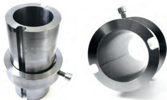
**Abb. 14:** Angefertigte Hülse für die Herstellung der benötigten Probenkörper für die Ermittlung von benötigten Materialparameter für die makromechanische Modellierung von Formstoffsystemen. Die am ÖGI konstruierte Hülse ist teilbar, was die zerstörungsfreie Entnahme des Gründruckprobenkörpers erleichtert [1].
