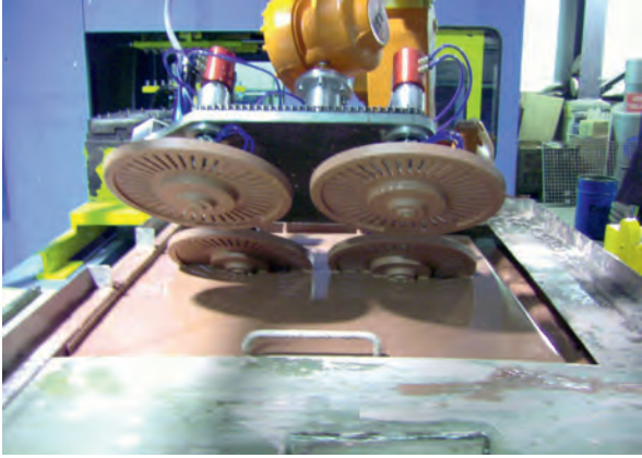
Das Eintauchen von Bremsscheiben-Kernen per Roboter in die Schlichte
