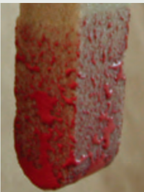
Abb. 3: Schlichte ohne ausreichend Netzmittel
