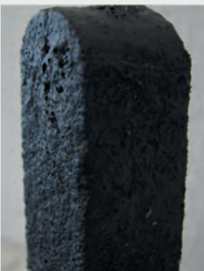
Abb. 4: Schlichte ohne ausreichend Entschäumer
