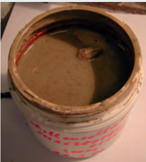
Abb. 5: Schlichte ohne ausreichend Konservierungsmittel
