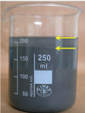
Abb. 6: Überstand einer Schlichte bei längerem Stehen
