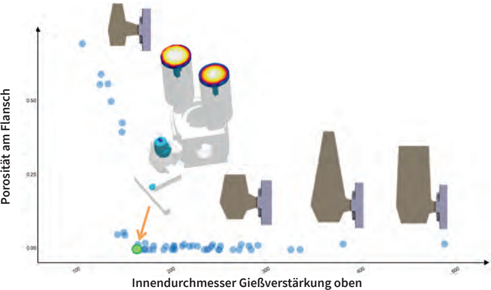
Bild 8: Einfluss von Form und Größe des heißen Speisers auf die Zielfunktionen „Porosität“ im Gussteil und „Speiservolumen“, dargestellt in einem Pareto-Streudiagramm (grüner Punkt entspricht dem optimalen Design)
