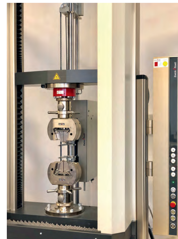
Zugprüfanlage Quelle: EBNER® Industrieofenbau GmbH
