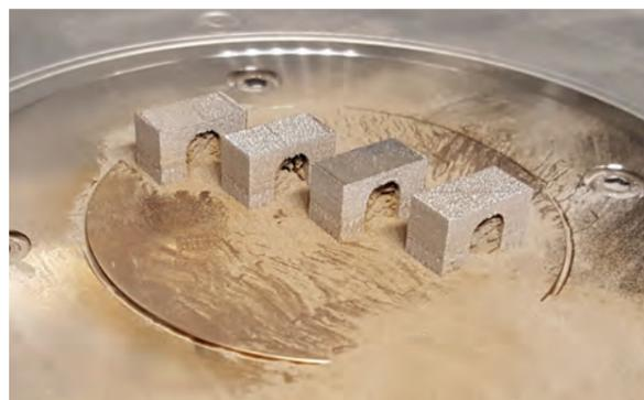
**Abb. 4:** Probenfreistellung der Torbögen von beheizbarer Substratplatte Quelle: eigene Darstellung.
