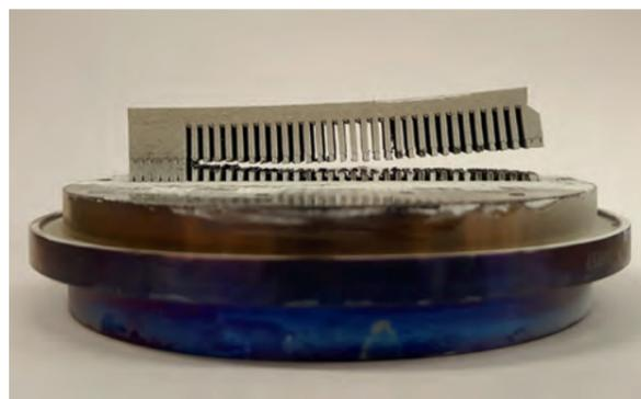
**Abb. 3:** Verkrümmung einer Probe nach Trennen von der Substratplatte als Indikator für hohe Eigenspannungen
