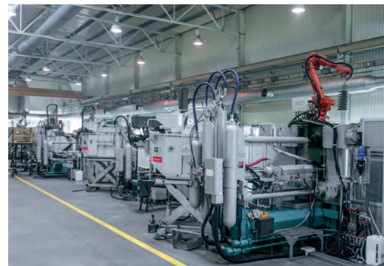
Im Vergleich zu Dosieröfen mit Pumpentechnologie überzeugt der Westomat durch geringen Wartungs- und Reinigungsaufwand. Bild: StrikoWestofen
