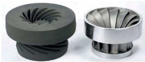
Abb.7: Additiv gefertigte Sandformen, Quelle: Voxeljet.
