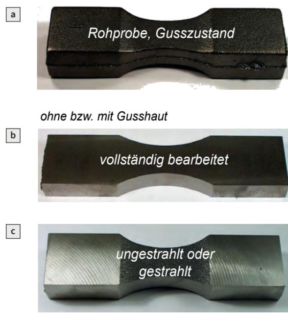
Bild 3: Flachbiegeproben für zyklische Dauerfestigkeitsversuche: a) im Gusszustand bzw. b) vollflächig bearbeitet und c) für Prüfung bearbeitet.
