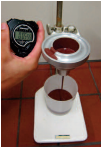
Abb. 5: Die Messung der Auslaufzeit ist ein guter Indikator für die Viskosität der Schlichte
