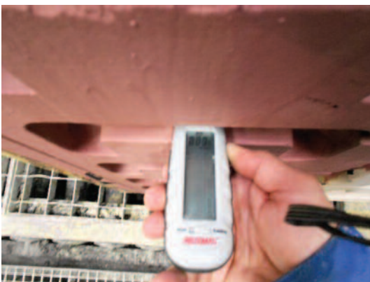
Abb. 2. Messung der Oberflächentemperatur der geschlichteten Form
