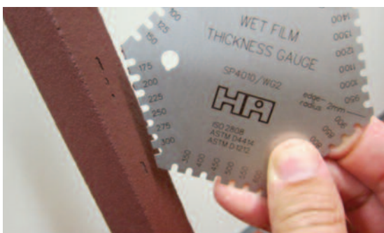
Abb. 10: Messung der Schichtdicke mit dem Nassschichtdickenkamm – hier 200 µm
