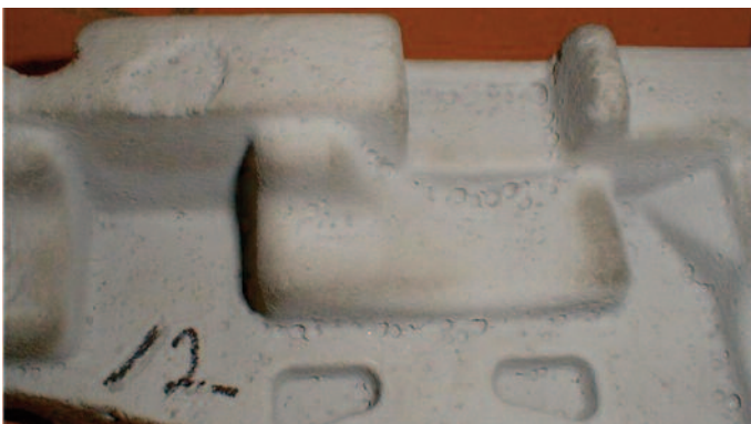
Abb. 1: Fehlerhafte Oberfläche verursacht durch Schlichteschaum
