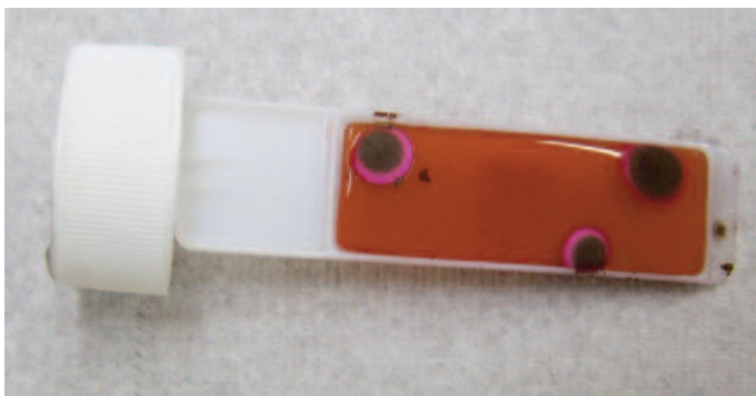
Abb. 4: Mithilfe von Keimindikatoren lassen sich Bakterien und Pilze auf einfache Art nachweisen
