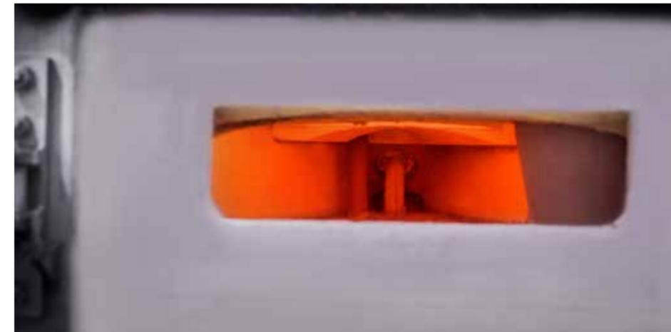
Abb. 1: Die Feuerfest-Auskleidung ist das Herzstück eines Ofens und trägt maßgeblich zur Energieeffizienz bei. Jedoch unterliegt sie dem Verschleiß und muss nach einiger Zeit erneuert werden. Bild: StrikoWestofen.
