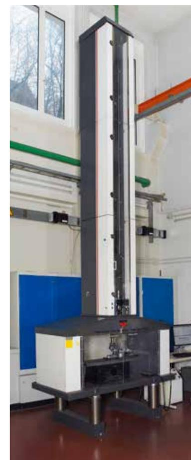
**Abb. 2:** 'Rosand' Schlagprüfanlage für instrumentierte Schlagversuche. Die Anlage besteht aus einem Turm, in welchem eine Masse von bis zu 103 Kg auf eine Höhe von max. 2500 mm gebracht und auf ein Prüfstück fallen gelassen werden kann. Während des Auftreffens auf das Prüfteil werden Weg und Kraft gemessen, sodass die Energie ermittelt werden kann, welche notwendig ist, die Probe zu brechen.
