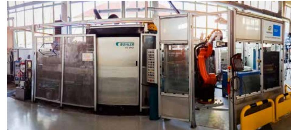
Abb. 5: Druckgusszelle des Lehrstuhls für Gießereikunde am ÖGI.
