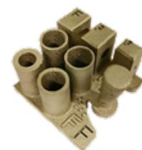
Abguss der Testgeometrie aus Messing - Sandgestrahlt
