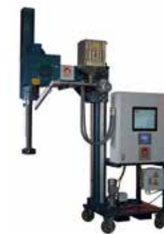
Abb. 1: MTS Behandlungsstation von Foseco mit Bedienerbildschirm der neuen SMARTT Software für den Entgasungsprozess
