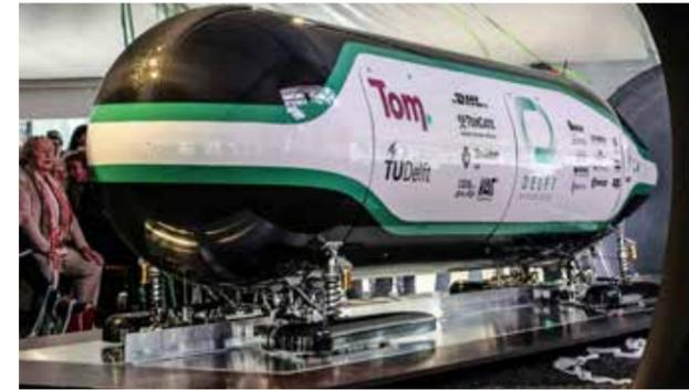
Abb. 1: Wie ein Wassertropfen geformt: Die Delfter Hyperloop-Kapsel erhielt eine aerodynamische Form und ähnelt einem Wassertropfen – die optimale Form für einen geringen Luftwiderstand.
