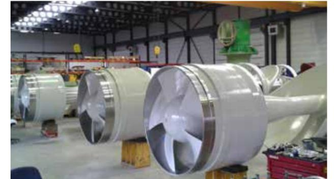
Abb. 2: Durchgängige Prozesskette: Die Firma Kleinken in Dorsten-Wulfen liefert fertig bearbeitete Gussteile, hier z. B. einbaufertige Pumpeneinsätze für Großwasserpumpen
