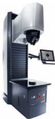
Die Firma EMCO-TEST stellt auf der Control in Stuttgart ab 9. Mai ihren neuen Härteprüfer DuraVision G5 vor, der einen einzigartig breiten Standardlastbereich mit einer großen Auswahl an Prüfmethoden für vielfältigste Einsatzmöglichkeiten verbindet.
