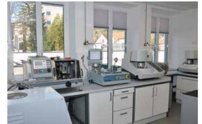
Abb. 10: Präzisionssägen und Poliermaschinen im Nassbereich der Metallographie.
