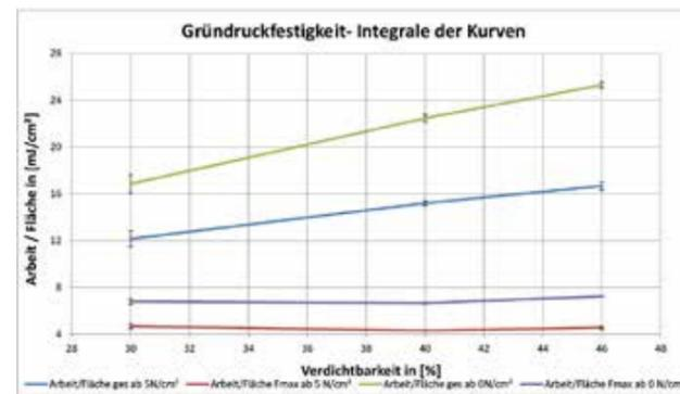
Abb. 10: Beispiel für „Prüfarbeit“ in Abhängigkeit der Formstoff-Verdichtbarkeit.
