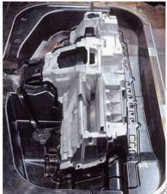
Magnesium-Instrumententafelträger des Rolls-Royces Phantom, Rohteil im Druckgusswerkzeug (BMW Group, Werk Landshut)
