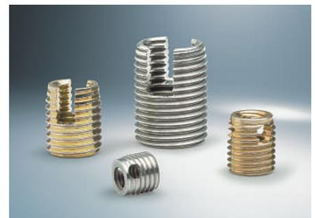
nichtrostendem Stahl sowie mit Schneidschlitz oder Schneidbohrungen verfügbar. Fasteks Gewindeeinsätze eignen sich besonders gut für den Einsatz im Leichtmetallbau, aber auch für alle anderen Materialien mit geringer Scherfestigkeit.
