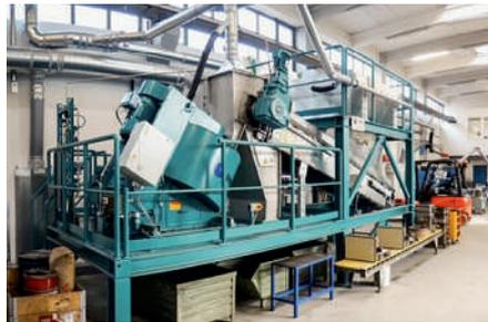
Abb. 11: Eirich-Mischer mit Absaugung.
