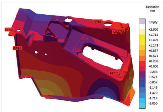
Abb. 12: Abweichung der Verformung des Bauteils von der Soll-Geometrie nach der Wärmebehandlung unter Berücksichtigung der Verformung aus dem Gießprozess für das Stützgestell 1 mit der RPS-Methode
