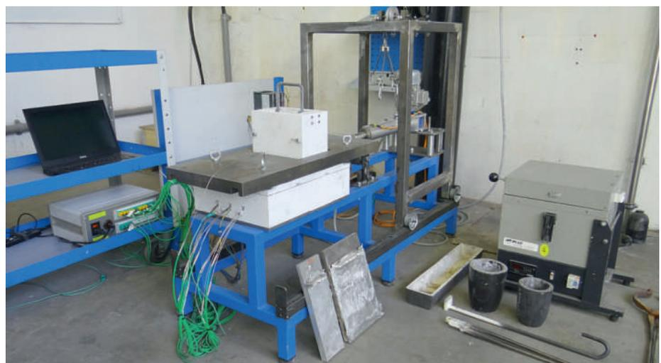
Abb. 3: Kleinanlage zur Durchführung von Verbundgussversuchen.
