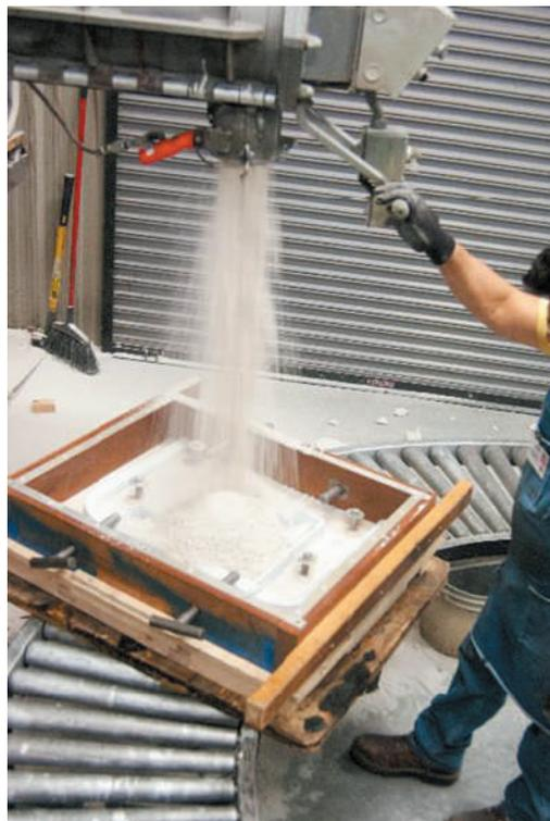
**Abb. 4:** Ein Gießereiarbeiter beim Erstellen einer der Testformen.
