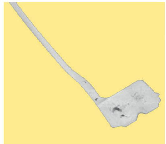
teile erzeugt [5]. Deshalb kann auch eine exakte Aussage zu den speziellen Bedingungen beim Gießen getroffen werden: Die Geschwindigkeit des Metallstroms am Anschnitt betrug 62,5 m/s und die Formfüllzeit 0,027 s. Das sind Werte, die nicht als extrem bezeichnet werden können (bekannte Extremwerte im angesprochenen Unternehmen betragen 70 bis 90 m/s).
