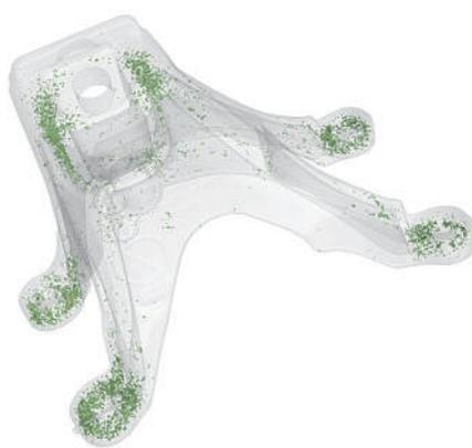
Abb. 8: Porenverteilung im Motortragbock
