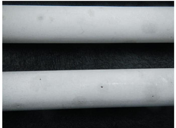
**Abb. 9:** Defekte treten durch Flüssigkeitseindringprüfung zugute
