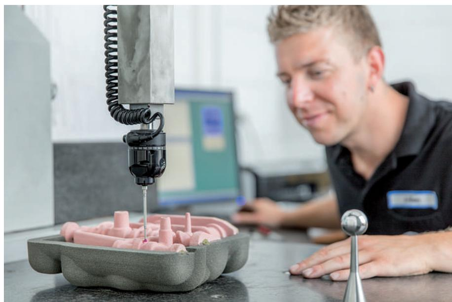
Qualitätskontrolle an einem 3D-gedruckten Kern für eine Ventilplatte
