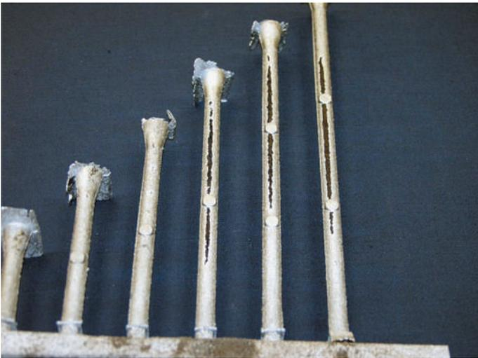
**Abb. 8:** Erkennbare Nichtbefüllung bei längeren Röhren mit einem Innendurchmesser von 0,250 Zoll (6,35 mm)
