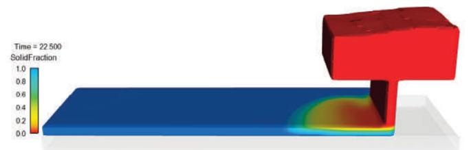
Abb. 12: Festanteil der Schmelze an der Oberseite der Aufgusslegierung zu Gießende
