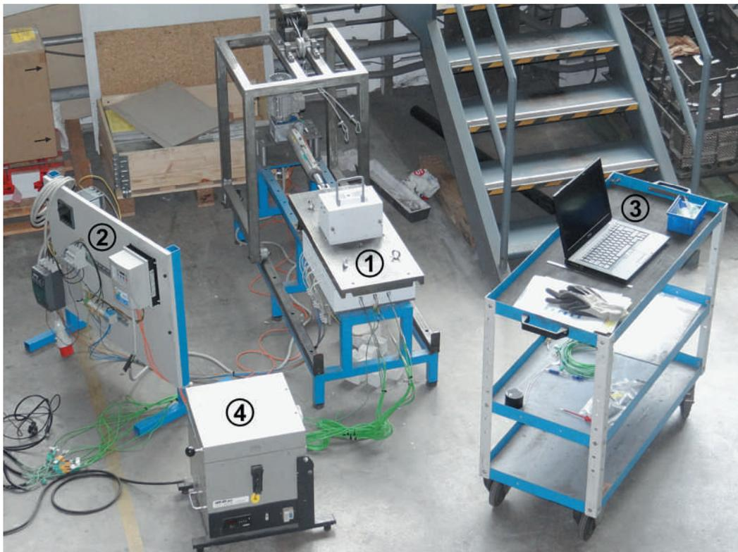
Abb. 1: Übersicht der Gießanlage (Gießeinheit (1), Steuereinheit (2), Datenaufzeichnung (3), Schmelzeinheit (4))
