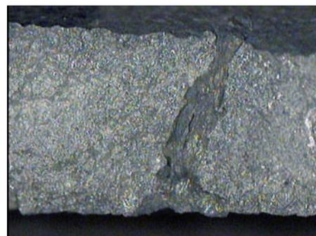
(b) Bruchstelle durch undichte Wand
