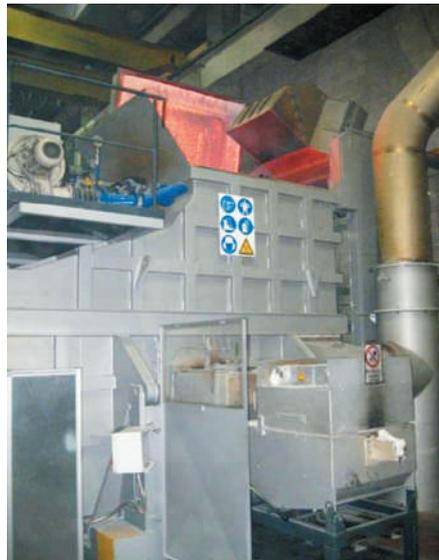
führt der längere Weg der Gase innerhalb der Schmelzanlage zu niedrigeren Emissionswerten, da nahezu alle Schadstoffe bei über 800 °C gewissermaßen nachverbrannt werden. Dadurch können die ZPF-Anlagen ohne Abgasfilter eingesetzt werden.
