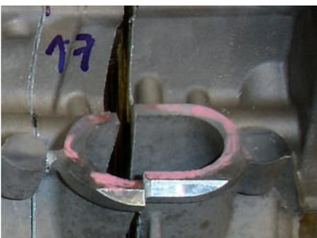
(a) Schnitt durch undichten Zylinderkopf
