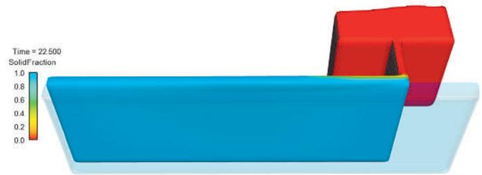
Abb. 10: Festanteil der Schmelze an der Unterseite der Aufgusslegierung zu Gießende
