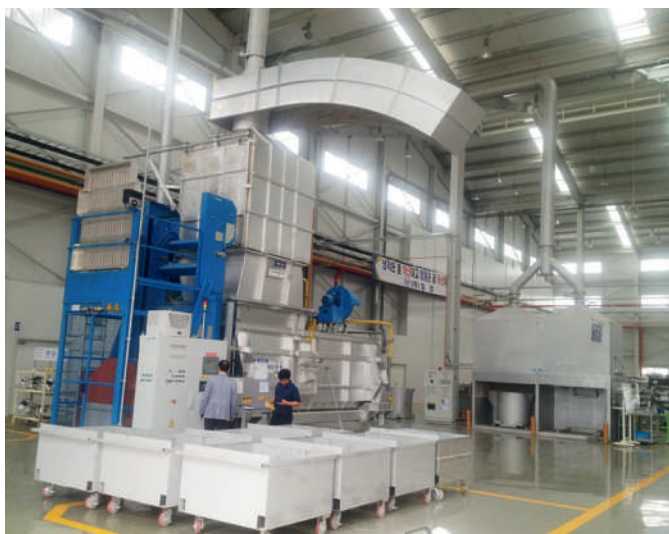
Neue Gießerei auf höchstem technologischem Niveau: Ein StrikoMelter-Schmelzofen von StrikoWestofen stellt das Kernstück der Schmelzanlage bei der Firma „Il Gangh“ in Südkorea dar (Bild: StrikoWestofen)
