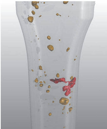
Abb. 9: Computertomographische Aufnahme einer Flachzugprobe mit den detektierten (eingefärbten) Porositäten.
