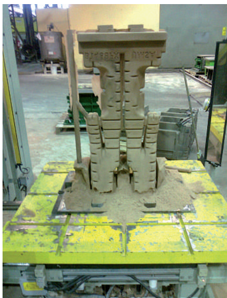
Erster Kernschießversuch. Der untere Kernbereich fällt aufgrund mangelnder Festigkeit vollständig in sich zusammen.
