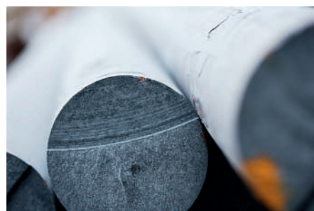
Strangguss-Rundstab aus hochsiliziumhaltigem Gusseisen mit Kugelgraphit mit homogenem Schnittbild der ferritischen Werkstoffstruktur Foto: ACO
