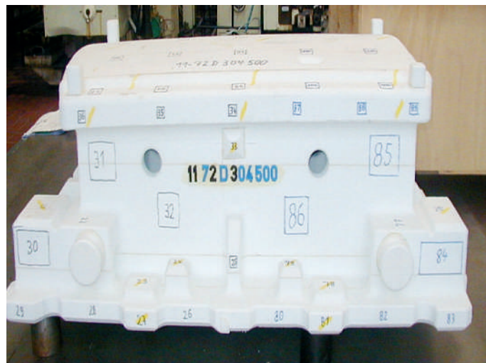
Abb. 13: Styropormodell; gut zu sehen sind die Montagelinien
