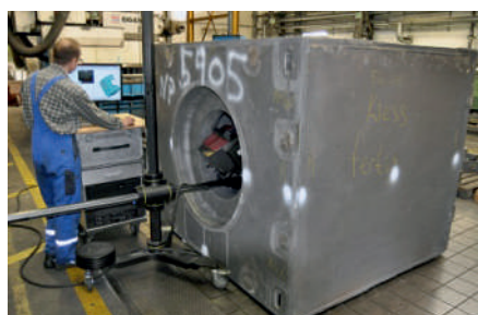
Vermessung eines Gusscontainers mit dem GOM-3D-Messsystem
