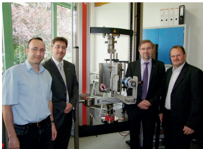
Abb. 15: Universalprüfmaschine Zwick 100 für Hochtemperaturmessungen. Im Vordergrund die ACR-Projektpartner: Prof. P. Schumacher (ÖGI), DI B. Schmiedinger (IBS), Prof. F. Hofer (ZfE) und DI G. Schindlbacher (ÖGI) (v.l.n.r.).
