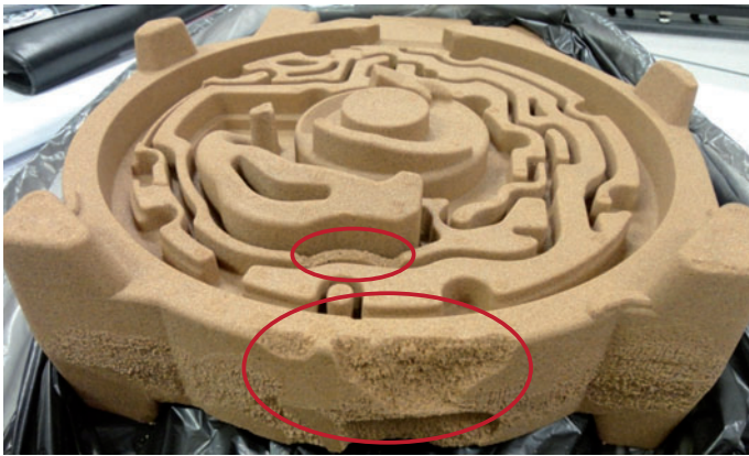
Bild 10: Fehlerhafter Kern nach der Aushärtung. Die markierten Bereiche zeigen die Stellen an, die mit den angewendeten Begasungsparametern nicht vollständig ausgehärtet wurden.
