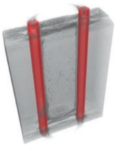
Bild 10: CT-Scan von in Guss integrierten Druckleitungselementen (Stahl)
