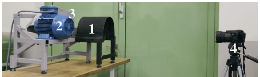
Bild 2: Experiment zur Bestimmung der Flüssigkeitsmitnahme mit der Drehzahl der Kokille (1, Kokillenstück; 2, Elektrischer Motor; 3, Getriebe; 4, Hochgeschwindigkeitskamera).
