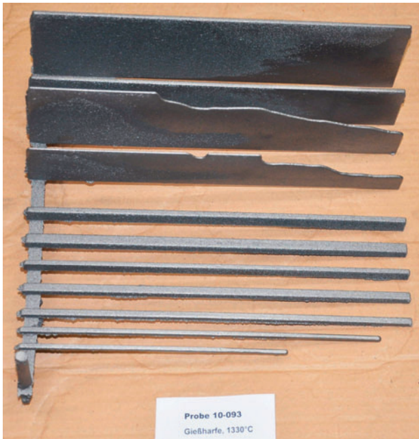
Bild 17: Füllversuche mit Gießharfe.
