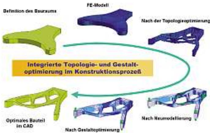
Bild 10: Ablaufdiagramm einer Topologieoptimierung nach [7].
