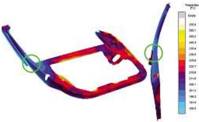
Bild 4: Temperaturverteilung für die optimierte Formtemperierung. Das Wärmezentrum im Bereich der Anbindung des Holmes wurde deutlich reduziert.
