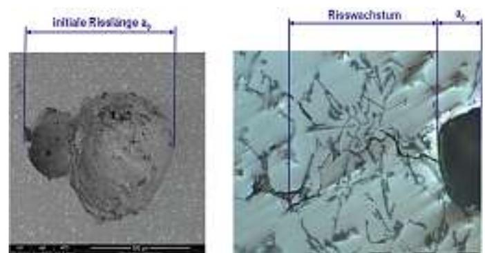
Abb. 7: Porengröße entspricht der initialen Risslänge (links); Risswachstum in der Mikrostruktur (rechts).
