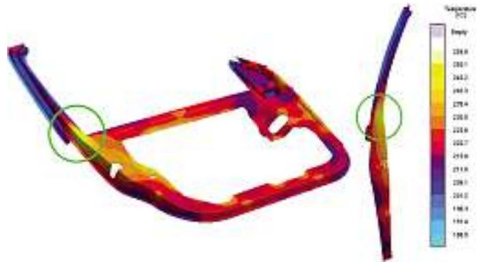
Bild 1: Temperaturverteilung zum Zeitpunkt des Auswerfens. Die hohen lokalen Temperaturen auf der Oberseite führen beim weiteren Abkühlen zum Hochbiegen des Fensterrahmens.
