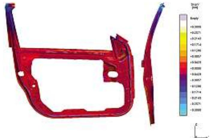
Bild 2: Geringe Verformung des Türrahmens innerhalb der Form kurz vor dem Auswerfen. Die Schwindung ist fast vollständig durch die Form behindert. Die Form ist transparent dargestellt. Die Darstellung ist um einen Faktor 15 überhöht.
