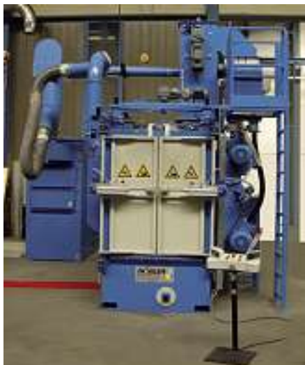
Bild 1: Die vollautomatische Kompakt-Hängebahn-Strahlanlage RHB 9/13-So wurde auf einer Fläche von nur ca. 1500 x 1500 mm realisiert.
