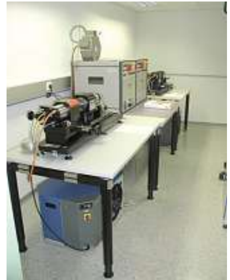
Bild 10: 4-Punkt-Umlaufbiegemaschinen mit Hochtemperaturofen (Fa. Walter+Bai)
