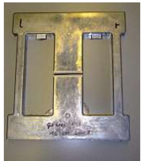
Bild 7: Entlang des Mittelsteges durchtrenntes Spannungsgitter
