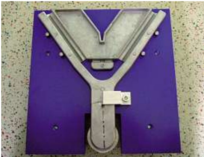
Bild 8: Auf eine Trägerplatte aus Aluminium zur Vermessung aufgespannte V-förmige Schale
