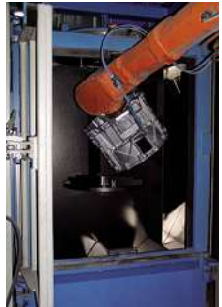
Bild 2: Der bauseits vorhandene 6-Achs-Roboter zur automatischen Beschickung wurde in das Strahlanlagenkonzept integriert.
