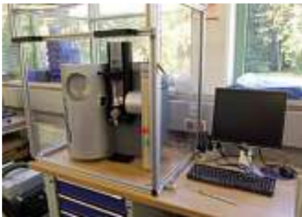
Bild 9: Lichtvermessungsgerät Tesa Scan 50 (Fa. Tesa)
