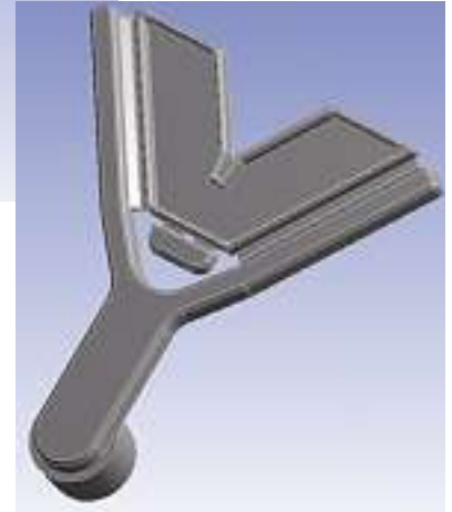
Bild 3: Geometrie einer V-förmigen Schale mit einem für das Druckgießverfahren konzipierten Gießsystem
