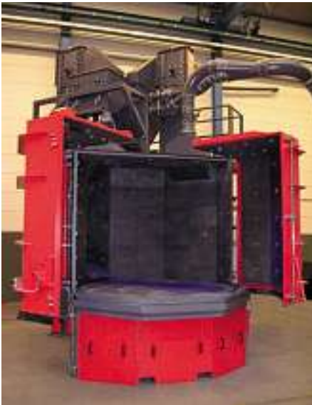
Bild 3: Die Integration eines so genannten geteilten Becherwerks ermöglichte die Platzierung der Drehtisch-Strahlanlage unter einem Kran. Lediglich der Sammeltrichter für das Strahlmittel und die Dosiereinheiten mussten über den Schleuderrädern angebracht werden.
