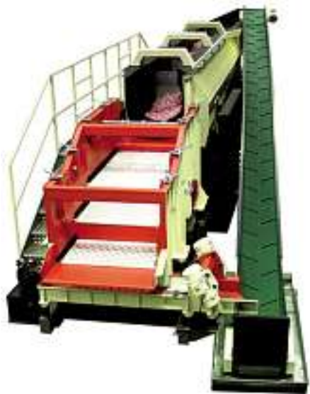
Bild 4: Die neue Generation der Linear-Durchlaufanlagen. 20 Prozent mehr Arbeitsbehälternutzvolumen ermöglichen einen höheren Durchsatz.
