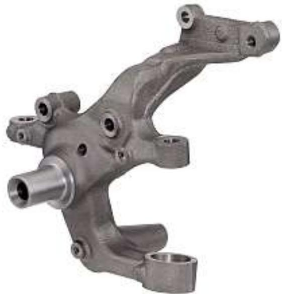
Bild 5: Der in laufender Serie von Volkswagen von Schmiedestahl auf Sibodur umgestellte Radträger der PQ 35 Plattform.
