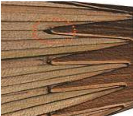
Bild 9: Computertomographie – Untersuchungen einer Keilzinkenverbindung in der Holzindustrie.
