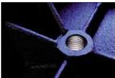
Bild 5: Detailaufnahme: Dünnwandiger Stahlguss. Foto: Evosteel
