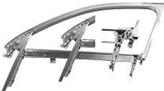
Bild 2: Die Rohbautüren der Fahrzeuge AUDI A4 und AUDI A3 haben Anbindebauteile aus der Legierung AlMg5Si2Mn und sind schweißgeeignet. Es werden jährlich 4,6 Millionen Bauteile gegossen.
