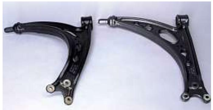
Bild 2: Querlenker aus Sibodur (rechts: Teil im Originalzustand, links: im Crash-Versuch verformtes Teil)
