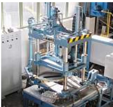
Bild 12: Niederdruckgießanlage.
