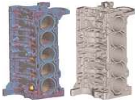
Wesentliche Verringerung der Reaktionszeit. Vergleich der Simulation (1) mit dem fertigen Gussteil (2)
