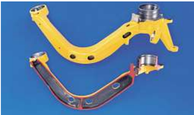
Bild 7: Leichtbau von PKW-Fahrwerksteilen: Dank des Herstellverfahrens Gießen sind Hohlstrukturen darstellbar, welche bei geringem Gewicht hohe Steifigkeit ergeben.
