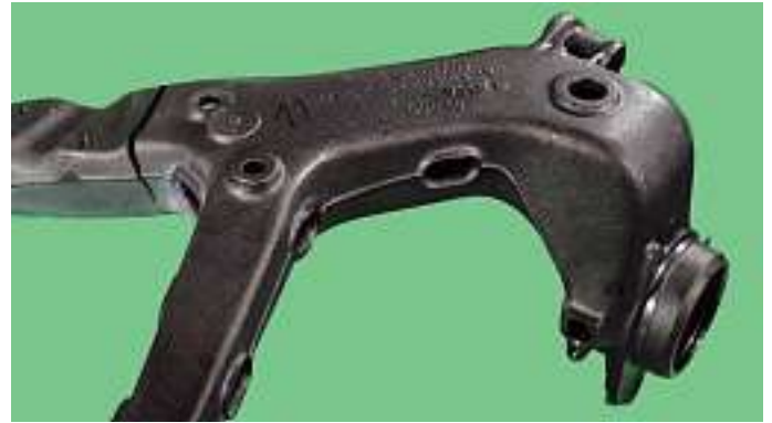
Bild 2: Fahrwerksteil (MPV-Schräglanker). Nach einer Schwingprüfung: Dank ‚weicher‘ Übergänge mit grossen Radien erfolgt der Bruch bei der Prüfung nicht in der Anbindung des Arms.
