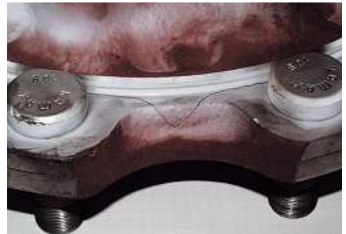
Bild 17: Technische Lösung von Übergängen durch bearbeitete Radian am Beispiel einer LKW-Nabe nach einer Schwingprüfung: Bruchausgang in den Radian.
