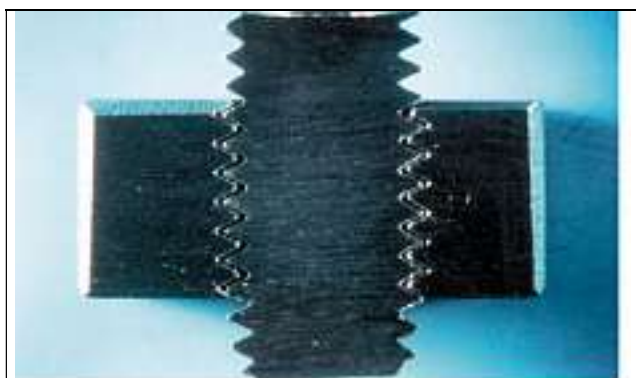
Abbildung 2: a) Profil einer Gewindefurchschraube (GF) mit kaltumgeformtem Muttergewinde, b) geschnittenes Gewinde
