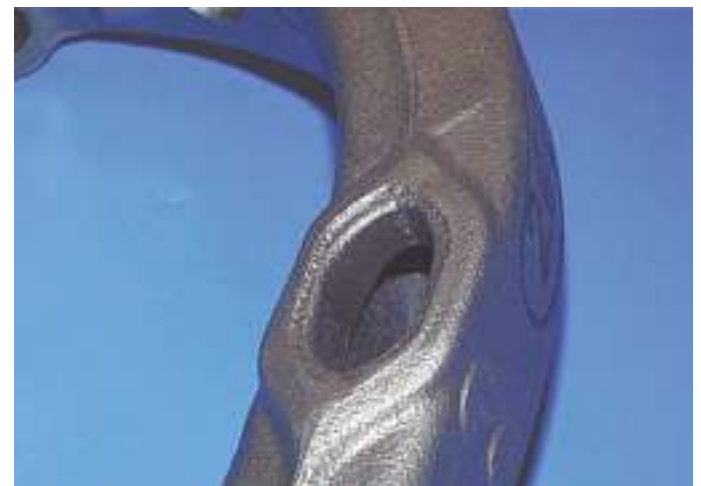
Bild 20 Um die Schwächung der Struktur durch notwendige Kerndurchbrüche zu kompensieren, wird an diesem Beispiel eines PKW-Schwenklagers der Durchbruch mit einem Wulst verstärkt.
