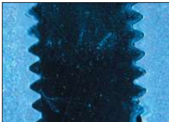
Abbildung 2: a) Profil einer Gewindefurchschraube (GF) mit kaltumgeformtem Muttergewinde, b) geschnittenes Gewinde
