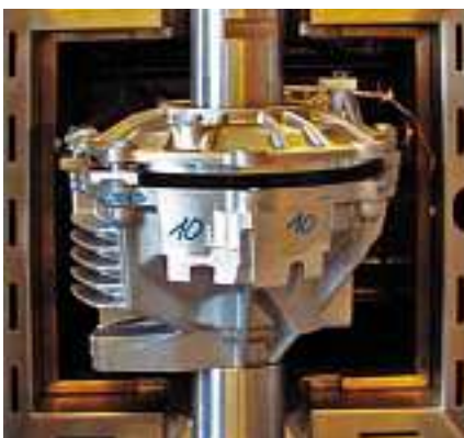
Abbildung 6: Aufbau der Messanordnung an einer Hydropulsanlage mit Temperatorkammer
