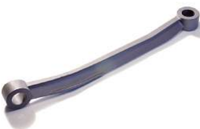
Bild 5: Gegossener Panhardstab für einen LKW, hergestellt aus EN-GJS-800-8 und aus EN-GJS-400-15 zur Untersuchung im Rahmen eines Forschungsprojektes
