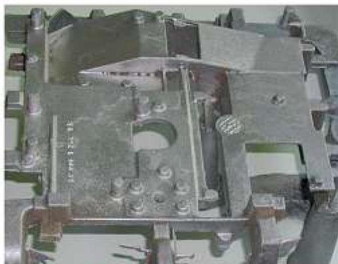
Bild 7: Oberfläche eines Magnesium-Gehäuses.
