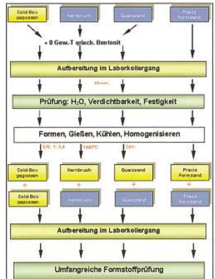
Bild 10: Fließschema des Versuchsablaufes.
