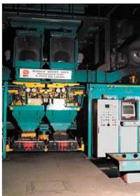
Bild 2: Zwillingsformmaschine mit einer Leistung von 200 Formen/h
