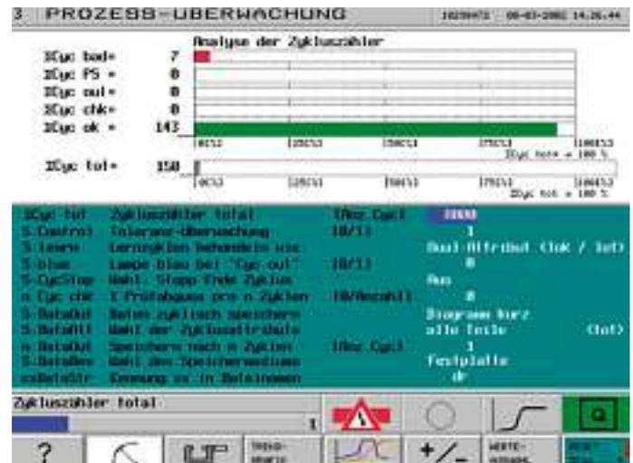
Bild 2: Prozessüberwachungsseite mit den Werkzeugen Trenddaten/Trendgraphik, Diagramm, Parametertoleranzüberwachung, Werteauswahl und SPC (im Hintergrund).
