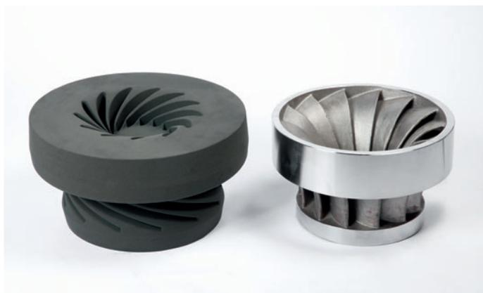
Abb. 1: Werkzeuglose Herstellung eines Laufrades: 3D-gedruckter Sandkern (links) und das finale Gussteil (rechts).
