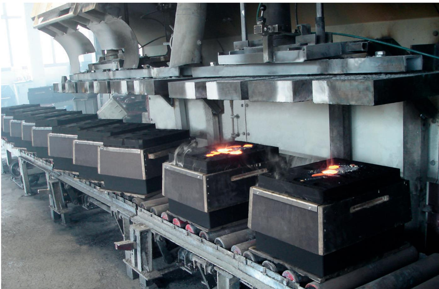
Abb. 2: Gießstrecke mit den abgossenen Formballen der FDNX. Zur Stabilisierung der Form werden Holz-Jackets aufgesetzt.
