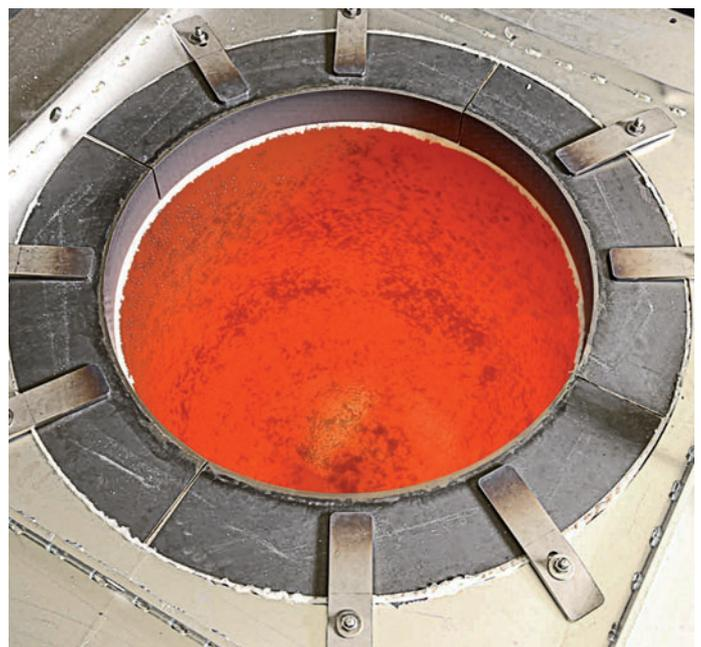
Abb. 6: Flammenfrei beheizter Warmhalte-Tiegelofen für Al-Schmelze
