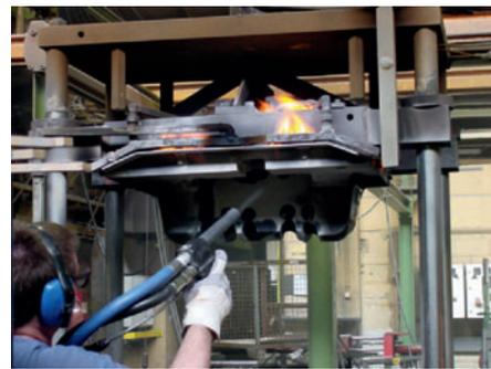
Effiziente Reinigung einer heißen Kokille direkt auf der Produktionsmaschine.
