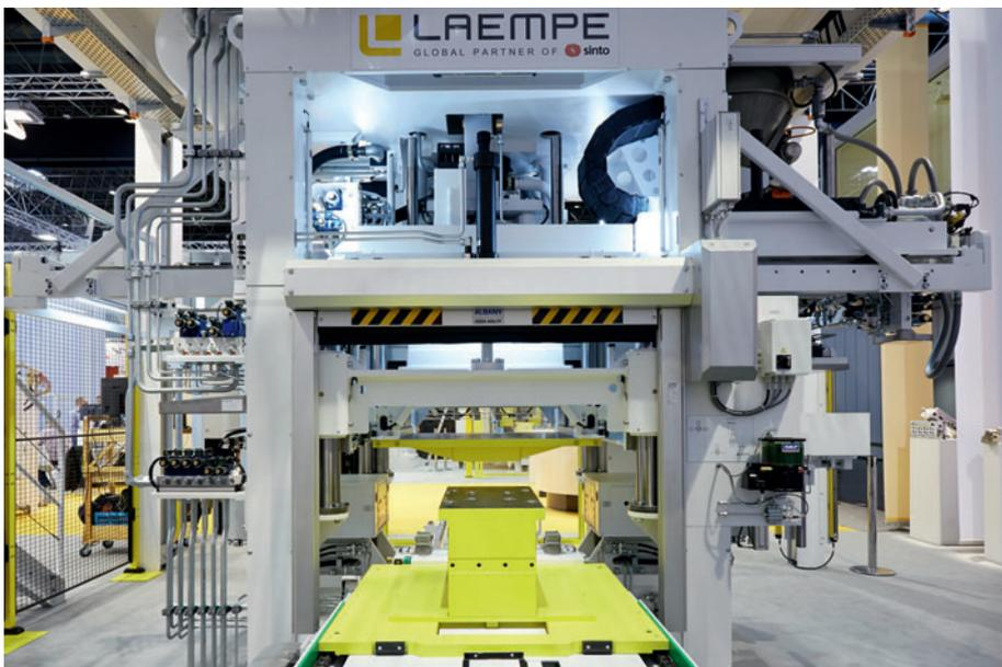
Die Kernschießautomaten der LHL-Reihe von Laempe Mössner Sinto zeichnen sich durch extrem schnelle Taktzeit und massivste Bauweise aus – diese Kernschießautomaten erfüllen anspruchsvollste Aufgabenstellungen.
