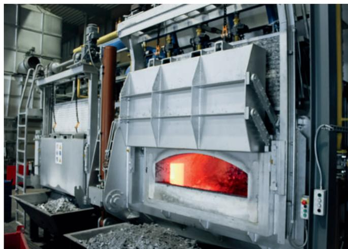
Abb. 5: Die Hub-Schwenktür sorgt für verbesserte Dichtigkeit und reduzierte Korundbildung.
