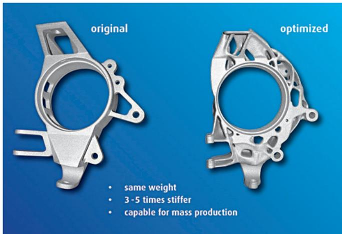
Abb. 10: Das Bauteil vor (links) und nach (rechts) der Optimierung. Mithilfe der Computersimulation und des 3D-Druckes lässt sich bei gleichem Materialverbrauch eine bis zu fünfmal höhere Festigkeit erreichen.
