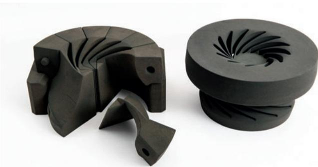
Abb. 8: Beispielhafter Sandkern eines Laufrades in traditioneller Herstellung (links) und im 3D-Druck (rechts).
