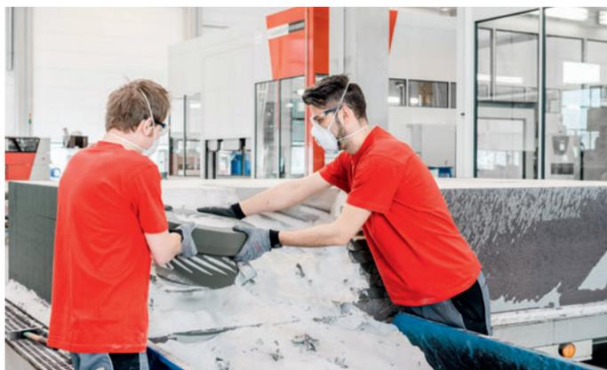
Abb. 3: Mitarbeiter entpacken die Formen nach dem Druck auf der VX4000 und befreien sie von überschüssigem Sand.
