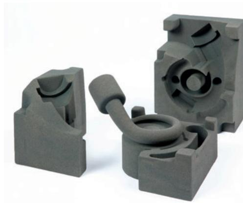
Abb. 6: Sandformen und -kerne können auch kombiniert gedruckt werden. Die Reduktion der Komponenten führt zu engeren Toleranzen.
