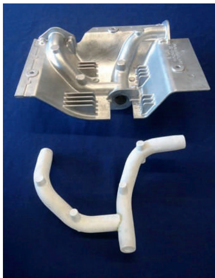
Magnesiumdruckgussteil mit versteifender Kanalgeometrie durch Gasinjektion
