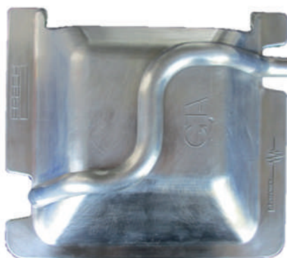
Salzkern und Druckgussteil mit Hohlraum
