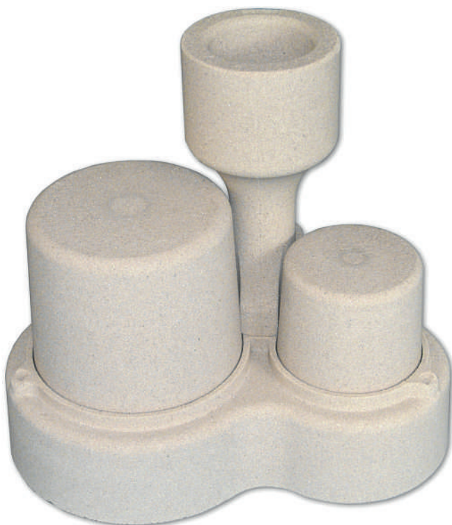
Abb. 1: Modulare Triplexprobe mit drei Sandmodulen: Durchmesser D = 30, 60 und 90 mm.
