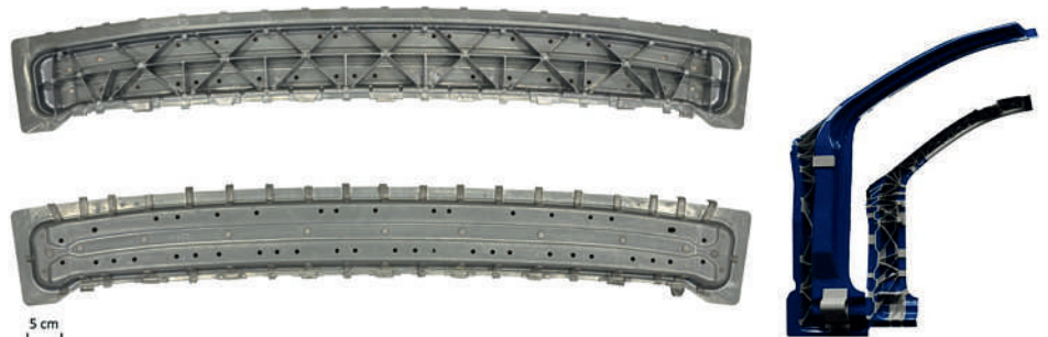
Karosseriestrukturbauteile in VarioStruct®-Bauweise; links: Prototyp eines hybriden Dachquerträgers (Stahlblech-Insert + Al-Druckgussstruktur); rechts: A-Säule (Modell)
