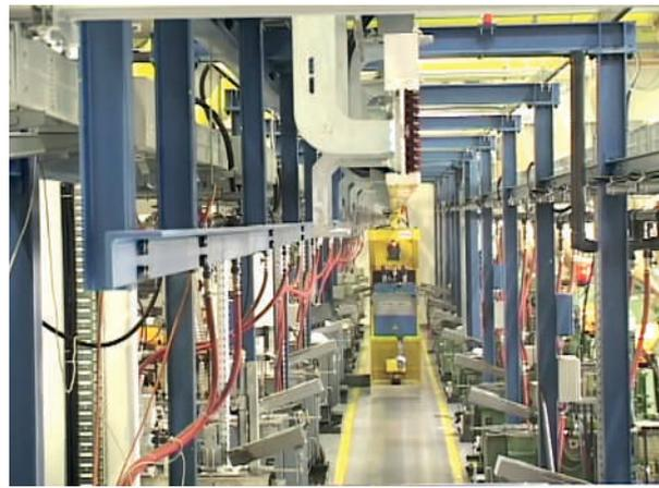
Abb. 11: Hängebahn mit Druckgießmaschinen in der Gießerei (Quelle: Meltec, Österreich)
