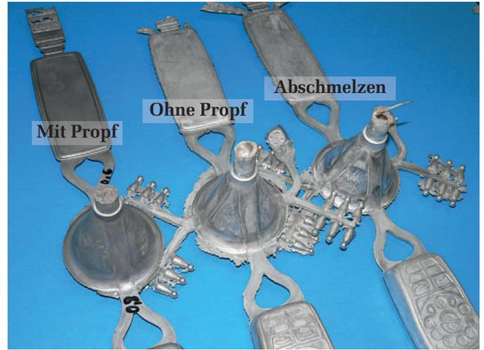
Abb. 15: Teile mit Pfropf, ohne Pfropf und mit Abschmelzen
