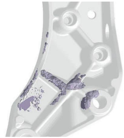
Die **Abb. 2 und 3** zeigen beispielhaft die erhaltenen Werte der Porosität (Grundlage: Auswertungen der Scans der Teile: 189, 192, 194, 195, 196, 197, 202, 204, 207, 208). Teilergebnisse der Simulation bezüglich der zu erwartenden Hotspots und Lufteinschlüsse sind aus den **Abb. 4 und 5** zu ersehen.
