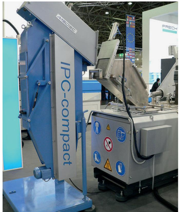
Abb. 10: Masselvorwärm- und -Chargiereinrichtung IPC Compact (Quelle: Meltec, Österreich)
