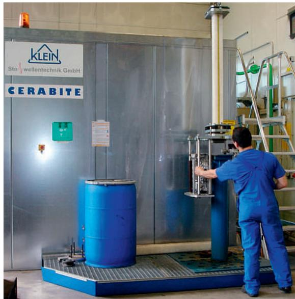
Bei der Stoßwellentechnologie zerstört eine hochenergetische, hochfrequente Schockwelle die Kernreste.
