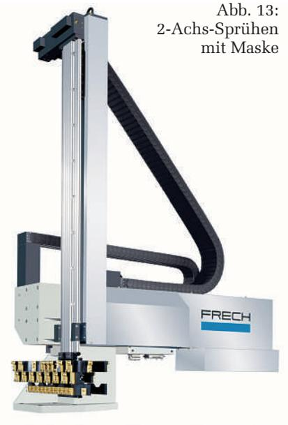
Abb. 13: 2-Achs-Sprühen mit Maske
