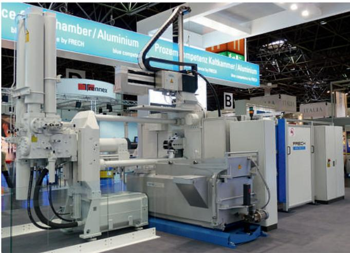
Abb. 1: Kaltkammer-Druckgießmaschine DAK 720-71 mit Vacural®
