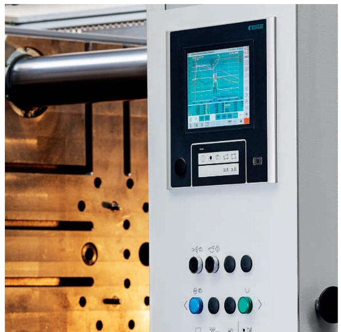
Abb. 4: Intuitive Bedienung – Die anwenderoptimierte Steuersäule mit grossem, farbigem Touch-Bildschirm und grafischer Oberfläche unterstützt die einfache Programmierung und bietet Hilfestellung während des Produktionsprozesses.
