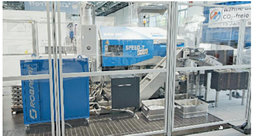
Abb. 7: Druckgießmaschine DAW 20 F mit Speed-T-Technologie
