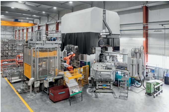
Ganzheitliche Betrachtung von Produktionsanlagen und Umfeld: Typische vollautomatisierte Druckgießzelle mit Dosierofen, Ablufthaube, Sprüherät, Entnahmeroboter, Stanze sowie weiteren Peripheriegeräten.
