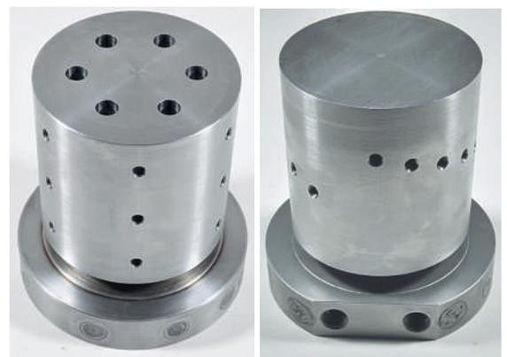
Abbn. 7 und 8: Prüfkörper I und II aus 1.2343
