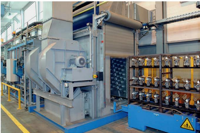
Bild 1: Luftabschreckkammer für Al-Strukturbauteile
