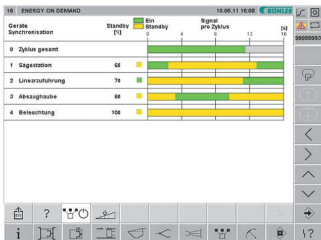
Bild 9: Ein Energiemanagementsystem in der Steuerung der Druckgießmaschine reduziert den Energieverbrauch der Peripherie (Grafik: Bühler)
