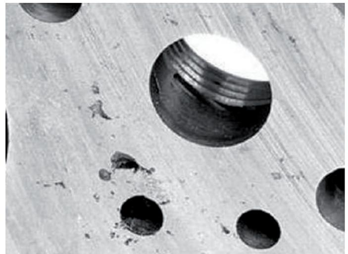
Abb. 2: Porosität an einer bearbeiteten Bauteiloberfläche
