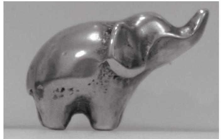
Abb. 1: Sichtbare Oberflächenporosität
