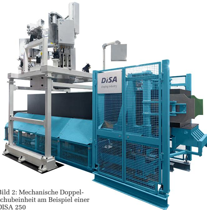
Bild 2: Mechanische Doppelschubeinheit am Beispiel einer DISA 250
