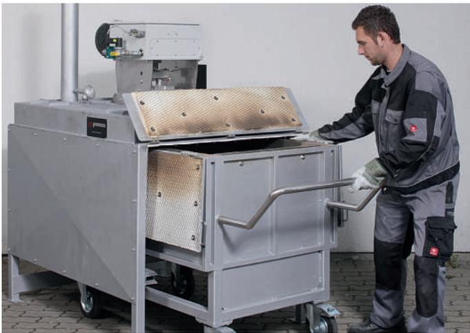
Bild 5: Haubenofen für Werkzeugtemperierung
