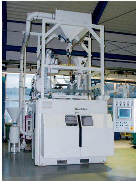
Bild 2: Für Versuche angepasste Kernschießmaschine Typ LBB 10 mit 10 ltr. Schussvolumen, Ausrüstung für alle gängigen Binderprozesse, Mischerdirektaufbau, Ultraschallvernebelungssystem für Schießeinheit und Schießplatte
