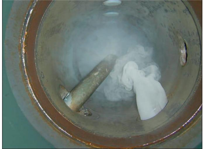
Bild 4: Ultraschallbenedelung der Schießeinheit
