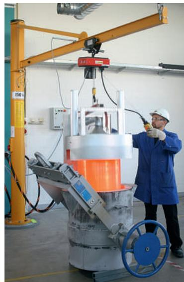
Bild 1: Pfannenbeheizungssystem für Aluminium (1,25 t); Brenner 100 kW, im Einsatz seit 2007.
