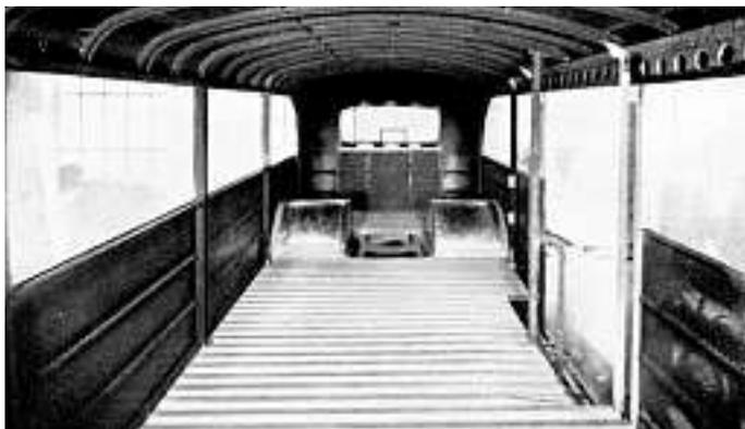
Abb. 1: Innenansicht eines Bustrailers aus Magnesium [2]
