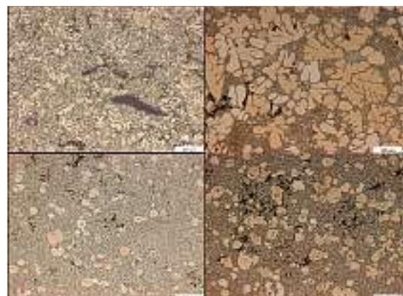
Abb. 11: Gefüge der AZ91 nach Druckguss (oben links), nach New Rheocasting (oben rechts) und nach Thixomolding mit niedrigem (unten links) und hohem Festphasenanteil (unten rechts)
