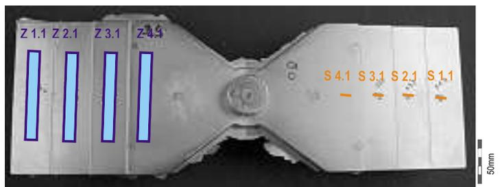
Abb. 3: Doppelstufenplatte; Lage der Schriffe und der Zugproben
