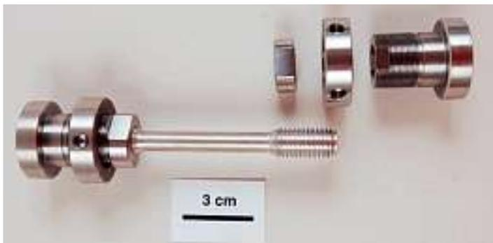
Bild 8: Optimierter Adapter aus Titan (mit Kontermutter) für Kleinproben-Prüfung
