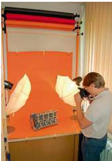
Bild 12: Fotostudio zur visuellen Inspektion von Gussteilen
