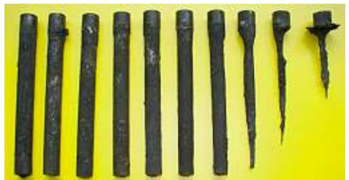
Abb. 10: Warmarbeitsstahlproben nach dem Rühren in Aluminiumschmelze (Versuchsdauer der Proben von links nach rechts: 1, 2, 3, 4, 5, 6, 8, 21, 26, 32 Stunden).
