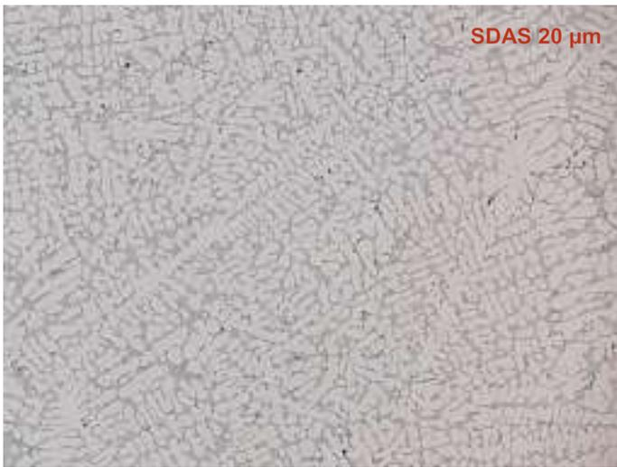
Abb. 7: Abguss mit Kühlekokille, Mikrogefüge 5 mm vom Rand, SDAS = 20 μm
