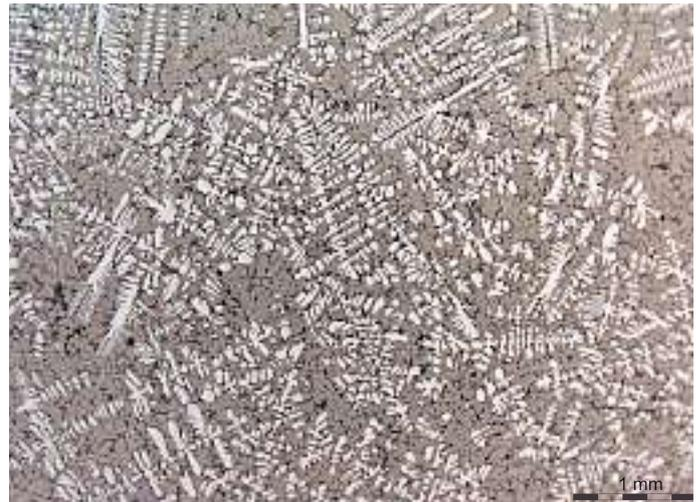
Bild 5: Matrixgefüge Al Si 12CuNiMg, bei guter Veredelung,  $\alpha$ -Al-Dendritennetzwerk (weiß) und veredeltes, feinfasriges (Al+Si)-Eutektikum (grau)
