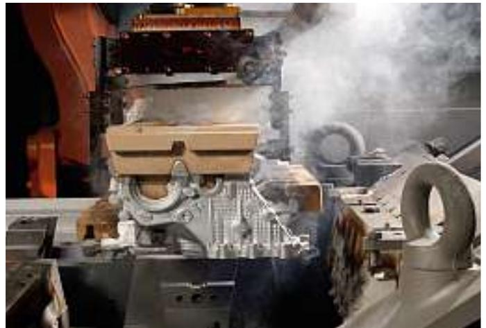
Abb. 1: Kerngas beim Abguss eines Zylinderkopfes mit organischem Binder
