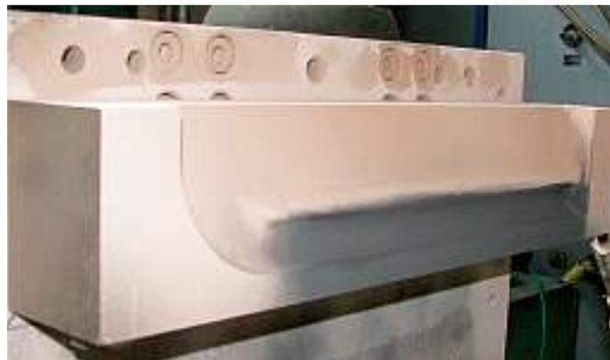
Bild 1: Aufgespannte Hälfte der Diez-Kokille, im Speiserbereich mit isolierender und im Probestabbereich mit leitender Schlichte versehen
