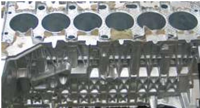
Abb. 3: Das Aluminium-Leichtbau-Kurbelgehäuse des Sechszylinder-Dieselmotors mit anorganischem Wassermantelkern
