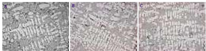
Bild 6: Mikrogefüge der Legierung A, DAS  $20 \pm 3 \mu\text{m}$ , gut veredelt; Legierung B, DAS  $20 \pm 3 \mu\text{m}$ , gut veredelt; Legierung C, DAS  $19 \pm 3 \mu\text{m}$ , sehr gut veredelt.
