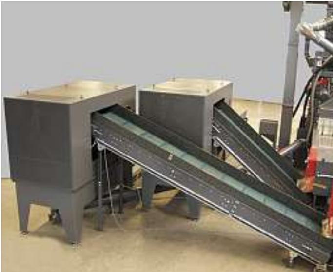
Bild 7: In Hohlräumen, Taschen und Vertiefungen zurückgebliebenes Strahlmittel wird mit Hilfe einer Entleereinheit vollautomatisch entfernt.
