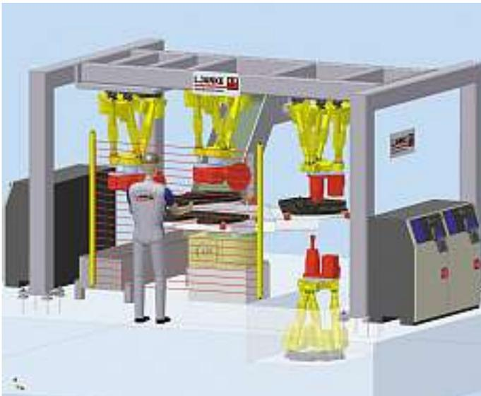
Bild 7: Entgratzelle für LKW-Kupplungsplatten mit 4 Hexapod-Robotern (Janke)
