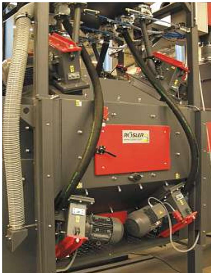
Bild 6: Acht Hurricane Hochleistungs-Schleuderräder sorgen für ein allseitiges, umfassendes Strahlergebnis ohne Schatteneffekte.
