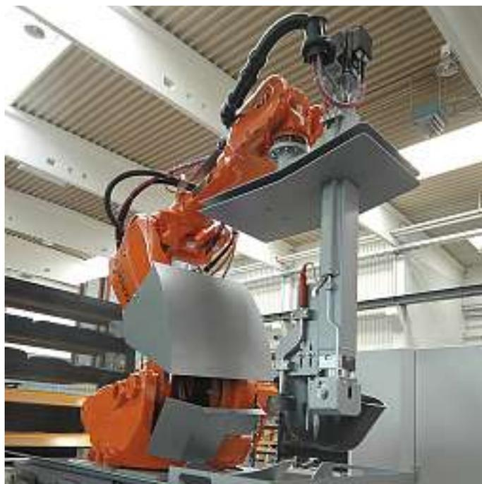
Bild 1: Roboter-Gießsystem robocast
