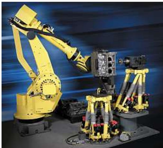
Bild 1: Entgratzelle für Motorblöcke mit 2 Hexapod-Robotern
