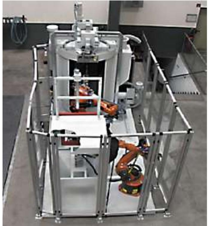
Bild 8: Der Rösler-Complete-Desander zum vollautomatischen Entsanden und Entgraten von mittelgroßen Gussteilen; Bestandteile der Anlage: taktend arbeitende Schleuderrad-Strahlanlage, Handlungsroboter mit Greifereinheit, Druckluft-Strahlkabine, Strahlroboter für die gezielte Düsenführung (Foto: Rösler Oberflächentechnik).
