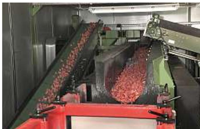
Bild 2: Die optimale Umwälzung von Chips und Werkstücken im Arbeitsbehälter gewährleistet eine gleich bleibend hohe Bearbeitungsqualität. Die Rückführung der kunststoffgebundenen Schleifkörper in den Prozess erfolgt über ein Transportband (links).
