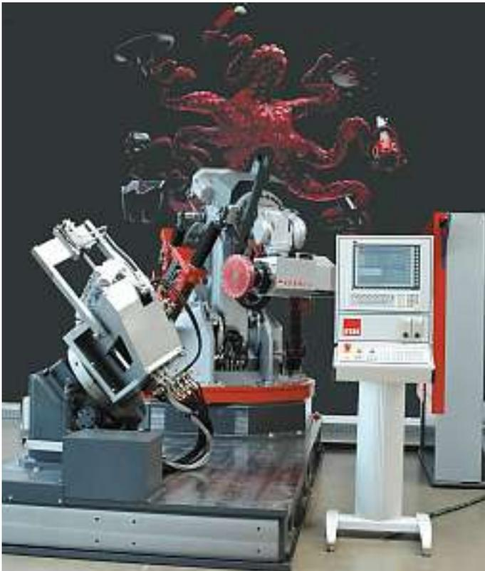
Bild 3: CNC-Roboter-Bearbeitungsmaschine robmill
