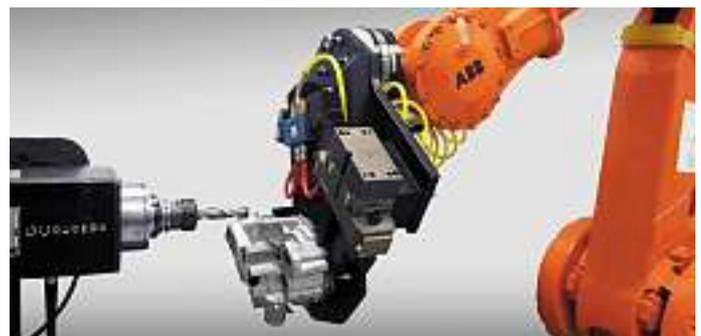
Bild 7: Durch den Einsatz von Robotern lassen sich beim Gussputzen zahlreiche Rationalisierungseffekte erzielen (Foto: ABB).
