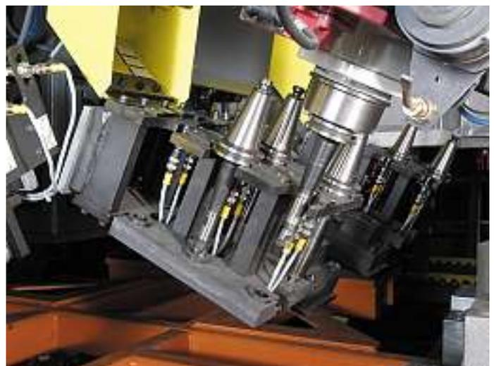
Bild 6: Automatisches Werkzeugwechselsystem
