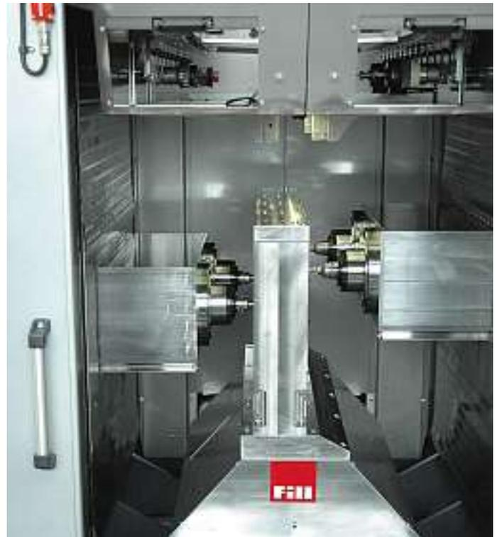
Bild 5: CNC-Fertigbearbeitungszentrum syncromill
