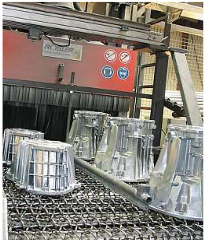
Bild 4: Wandler- und Getriebegehäuse aus Aluminium-Druckguss werden in einer vorgegebenen Taktzeit von 12 Sekunden entgratet und einem Oberflächenfinish unterzogen.
