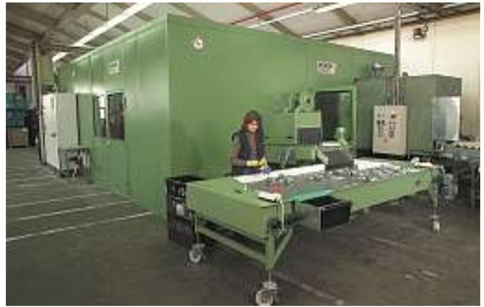
Bild 3: Nach dem Gleitschliffprozess werden die Teile mit gegenläufigem Spezialstauband auf den Speichertisch ausgegeben. Hier erfolgt eine 100%-Sichtkontrolle der Teile.
