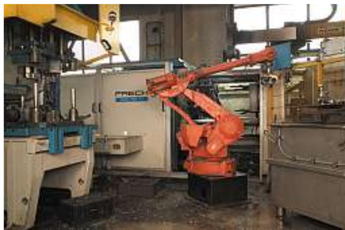
Bild 1: Produziert werden die Spiegelkomponenten in acht modernen, vollautomatischen Frech Gießzellen mit integrierter Entgratstanzeinrichtung.
