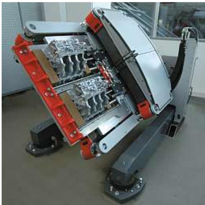
Bild 2: Entkerntechnik swingmaster sm 315
