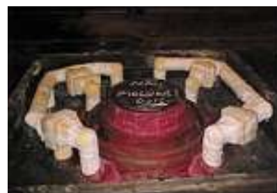
Bild 24: Keramische Filterpositionen für quadratische Filter der Größe 150x150
