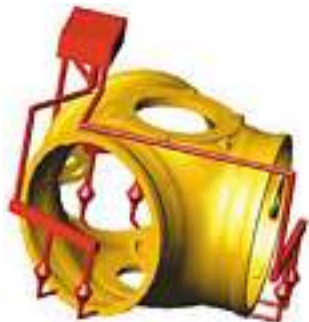
Bilder 20b/c: Filter in keramischen Filterhaltern nahe den Anschnitten platziert
