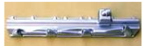
Der Rohteil: LxBxH = 600x100x70 mm, Werkstoff: G-ALSi 7MgCuSr, Gewicht 1500 g, Härte 103 HB
