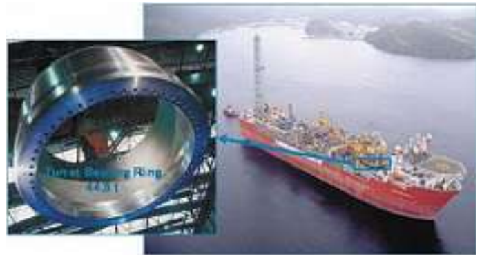
Abbildung 4: Bohrschiff mit Förderung und Verankerung durch den Schiffsrumpf und ein Beispiel für eine zugehörige Komponente aus Stahlguss
