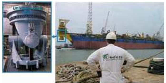
Abbildung 5: Bohrschiff mit Förderung und Verankerung über eine am Bug angebrachte Bohr- und Verankerungsstation und das aus 3 Gussteilen bestehende zugehörige Kardangelen
