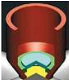
Bild 14: TA Speiser mit integriertem Kern zur Filterplatzierung
