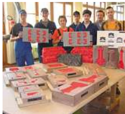
Eine beachtliche Leistung: Für das Einförmigen sind 2 Modellhälften, 9 Kernkästen, 2 Wassermantelkerne und 2 Modellplatten erforderlich.
