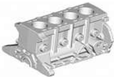
Der Motorblock des ABARTH 2000 (4 Zylinder, 2 Liter, 275 PS) ist aus Grauguss GG-25, Gewicht 46 kg.
