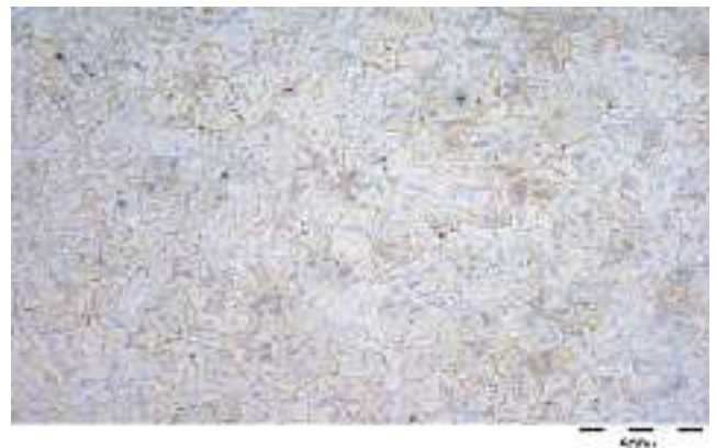
Bild 4: Gefügebild von Magnesium mit feinen Kristallkorngrößen
