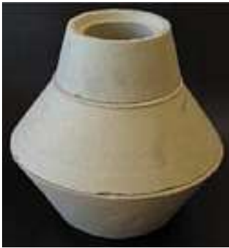
Bild 12: Keramik-Filterpositionsmodell für horizontales Positionieren
