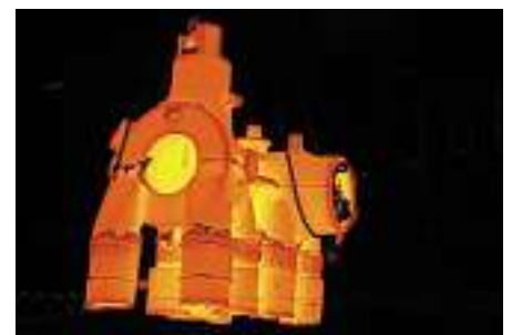
Versuchsventil aus Alloy625 beim Lösungsglühen (1200 °C) vor dem Abschrecken in Wasser
