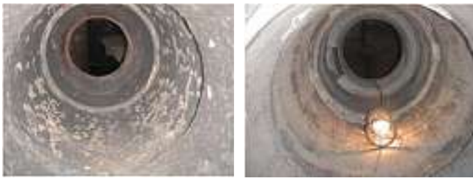
Bild 25a: Abguss ungefiltert Bild 25b: Abguss gefiltert Blick in den Innenraum zweier gegossener Rollen
