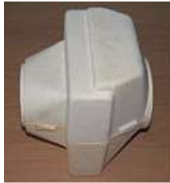
Bild 13: Keramik-Filterpositionsmodell für vertikales Positionieren
