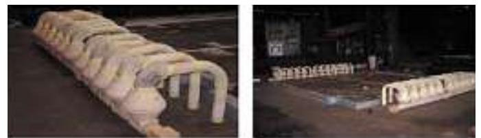
Bilder 22a/b: Zwei Reihen mit Durchmesser 200 keramischen Filterpositionen kamen beim Gießen dieses 25,5 t GJS-Gussteiles zur Anwendung
