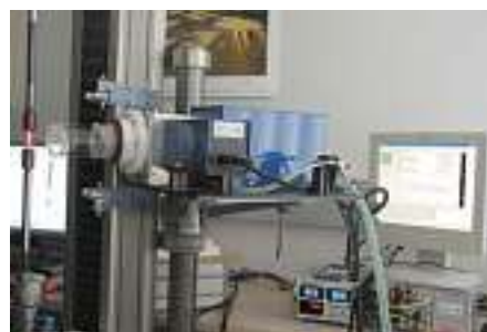
Bild 6: Laserextensometer zum berührungslosen hochauflösenden Messen von Dehnungen
