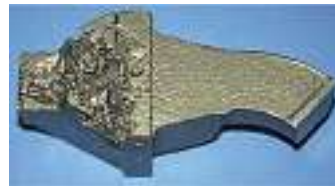
Bild 8: Abscheidung von großen Einschlüssen in der Filterkammer vor dem Filter
