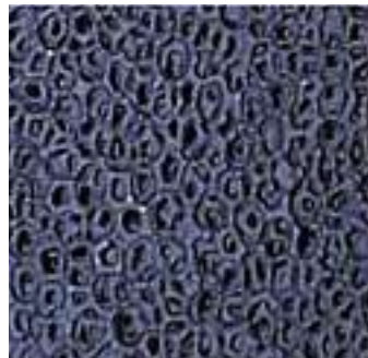
Bild 6: Die einzelnen Zellen sind durch pentagonale Öffnungen unterschiedlicher Größe verbunden
