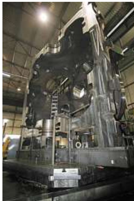
95 t Dampfturbinengehäuse beim Vorschruppen
