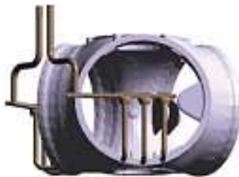
Bild 20a: Filter auf der Formteilung platziert
