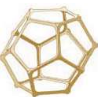
Bild 5: Eine ideale Schaumkeramik-Zelle hat die geometrische Form eines Dodekaeders
