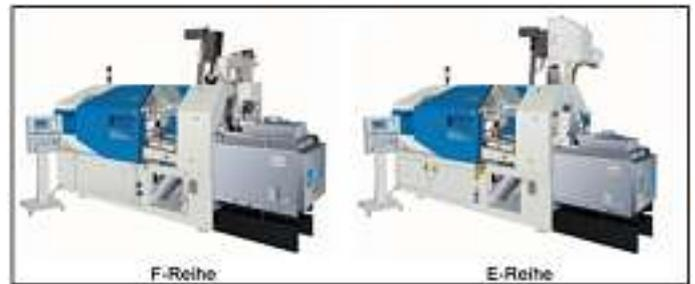
Bild 2: Neueste Warmkammer-Druckgießmaschinen-Reihe
