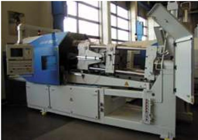
Bild 4: DAW 125 F: geöffnete Haube mit guter Zugänglichkeit für Rüst- und Wartungsarbeiten
