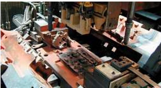
Bild 18 – Einlegen eines Kernpaketes in die ROTACAST®-Kokille
