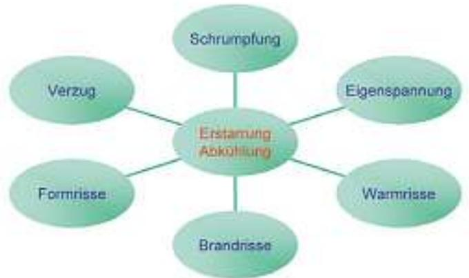
Bild 2: Auswirkungen auf Gussteil und Werkzeug durch die erstarrende und abkühlende Schmelze
