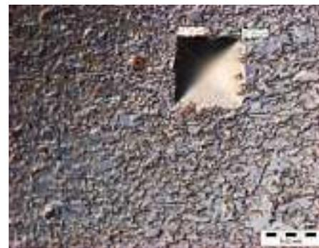
Bild 8: Automatische Härteeindruckvermessung
