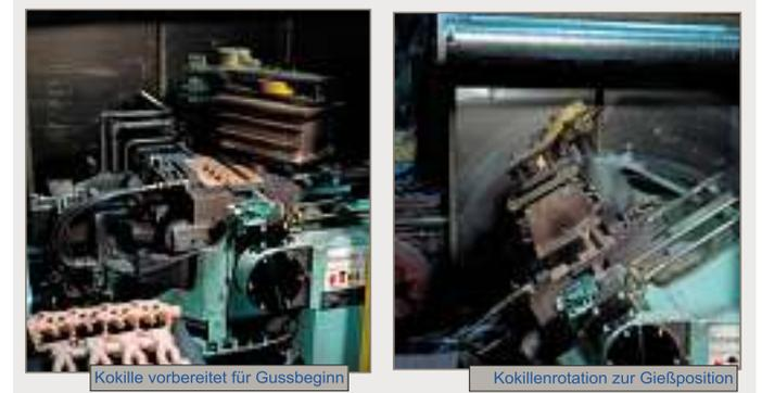
Bild 21 – Der ROTACAST®-Prozess
