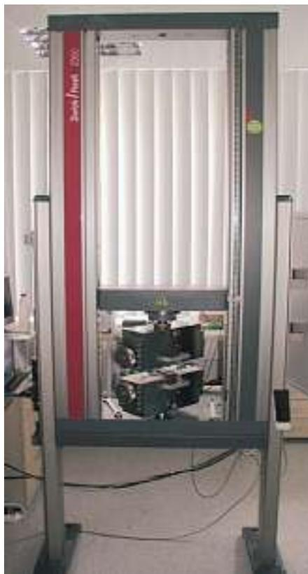
Bild 7: Universal Materialprüfmaschine für Lasten bis zu 50kN
