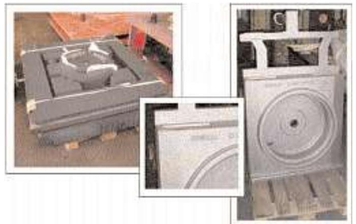
Gefräste Formsegmente und Kerne (links) für extrem schnelle Herstellung eines besonders maßhaltigen Rundtischgehäuses (rechts).
