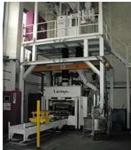
Bild 2: Kernschießmaschine Laempe LB 25 mit Sandaufbereitung
