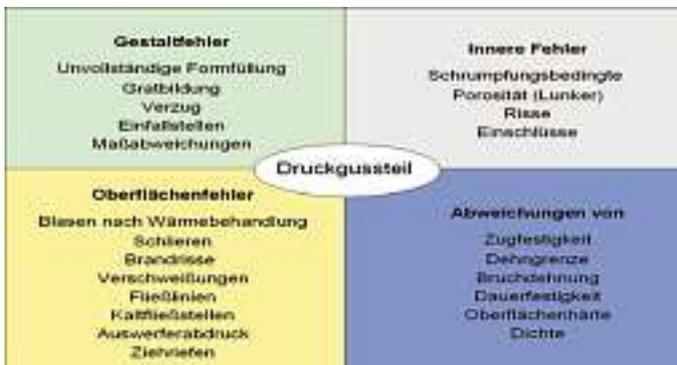
Bild 11: Typische Fehler bei Druckgussteilen [1][2]
