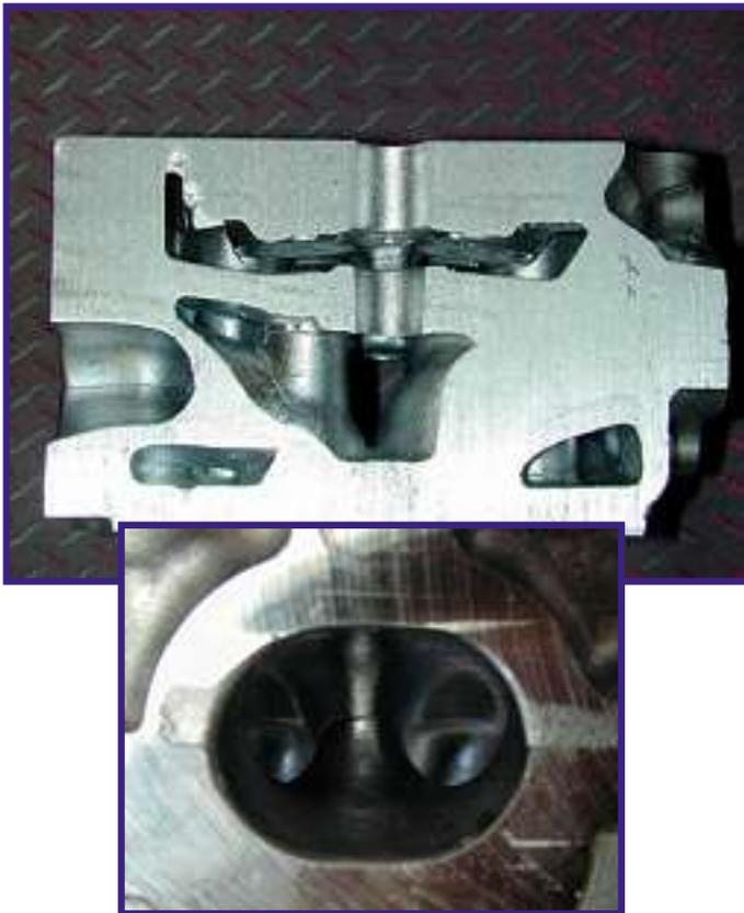
Bild 7: Gussfläche nach mechanischer Entkernung, Kerne aus Olivinsand
