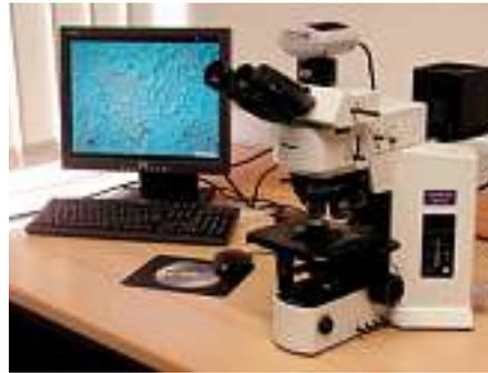
Bild 6: Metall-Lichtmikroskop mit digitaler Bildanalyse.
