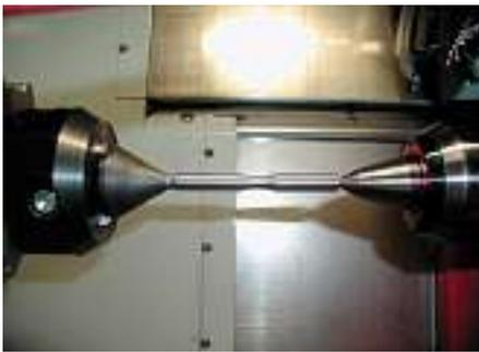
Bild 4: Probenfertigung im neuen CNC Drehautomat.
