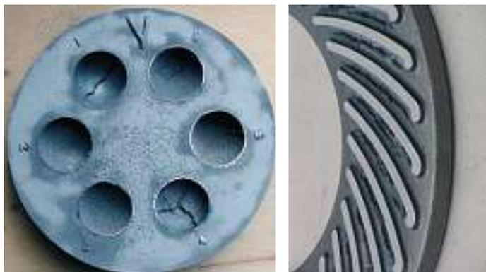
Bild 1: Blattrippen bei einem Testgussstück und in der Verrippung einer innen ventilerten Bremsscheibe
