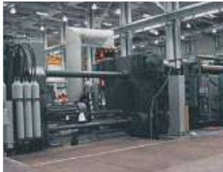
Bildunterschrift: Bühler-Druckgießmaschine mit 40.000 kN Schließkraft
