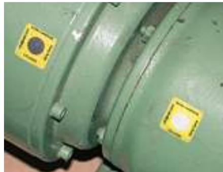
Elektromotor mit aufgeklebten Temperatur-Kontroll-Etiketten Jumbo-CelsiDot® (gelbe Stellen)
