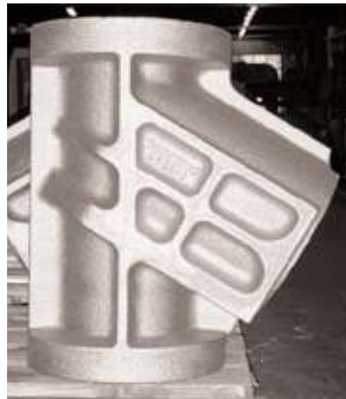
Bild 4: Rohgussteil Armaturengehäuse (Foto: Heidenreich & Harbeck AG Mölln)
