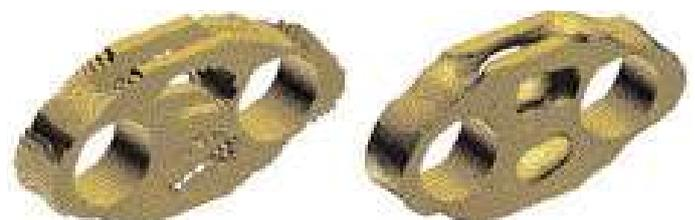
Bild 16: Topologieoptimierungsergebnis bei Homogenisierung der Schädigung
