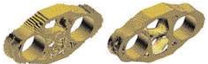
Bild 15: Topologieoptimierungsergebnis bei Minimierung der Verzerrungsenergie
