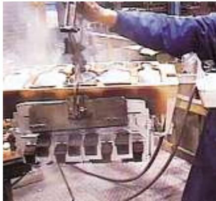
Bild 2: Zylinderkopf mit Gradientengefüge [10]
